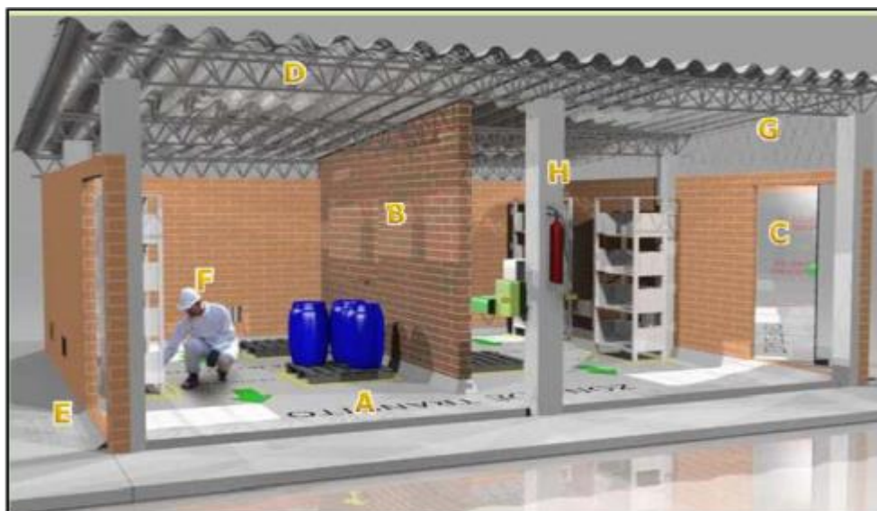
Figura 5. Característica estructural del Área Especial de Acopio Residuos Sólidos Peligrosos
