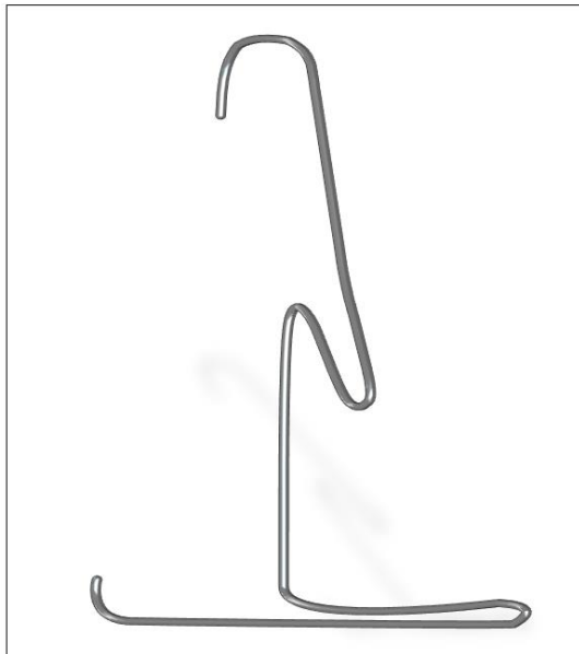
Figura N°06: modelo de gancho de alambre galvanizado de 55 cm de longitud
