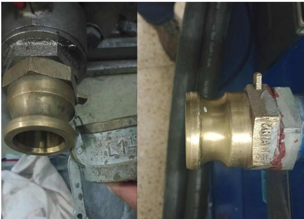
Foto 01 : Conectores macho de acople rápido de Aluminio Tipo C – Camlock de \varnothing 1.1/2'' en la salida y entrada de aceite dielectrico en el equipo de tratamiento.
