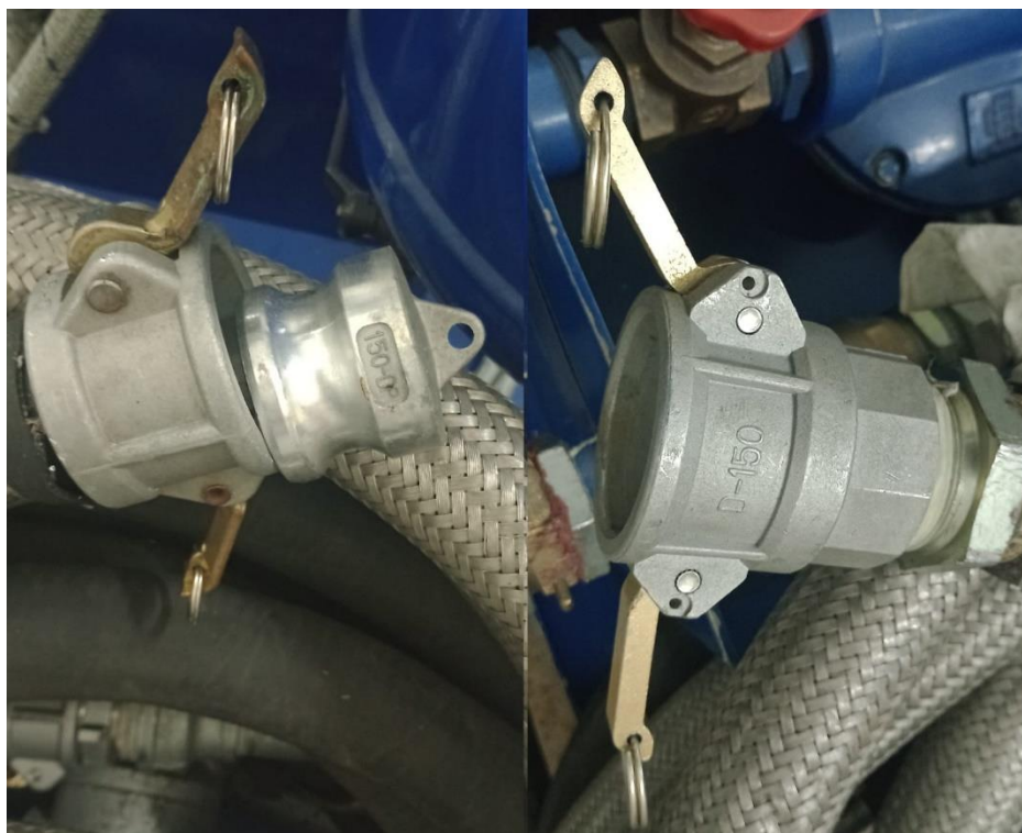
Foto 02 : Conectores hembra de acople rápido de Aluminio Tipo C – Camlock de \varnothing 1.1/2'' en las mangueras de salida y entrada de aceite dielectrico en el equipo de tratamiento.
