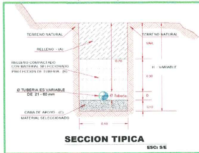
FIG N°09. Sección típica de zanja en línea de aducción y distribución
