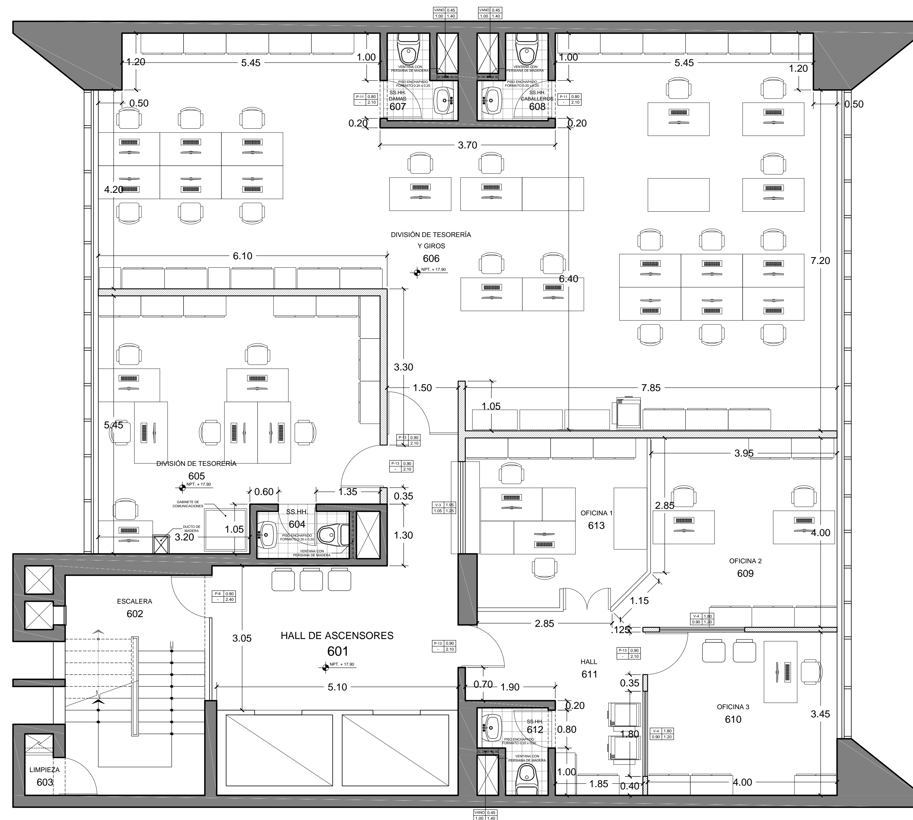
PLANO: LEVANTAMIENTO DISTRIBUCIÓN - 6TO PISO ESCALA: 1/50
