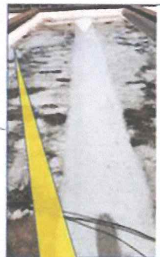
Inundación de techo para verificación de tiempo
