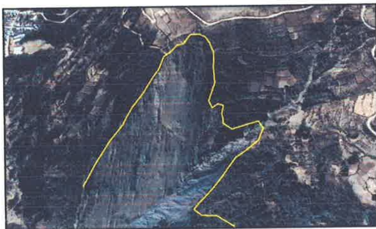
IMAGEN 06. Zona inestable, cabecera de la quebrada, es el trayecto de L. de conducción.
