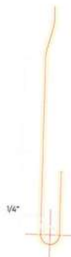
DETALLE C: GANCHO DE SOPORTE Escala 1:10
