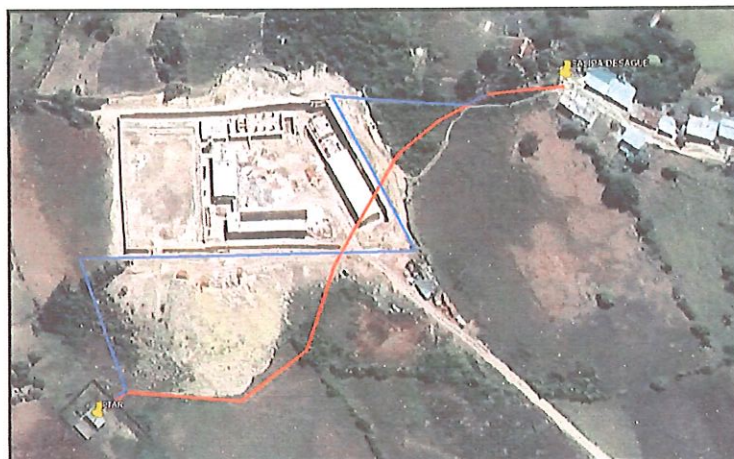
Figura 01. Red de desagüe existente y red de desagüe proyectada.
