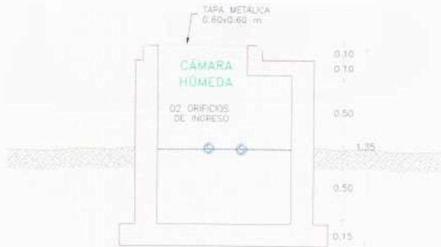
CAPTACIÓN DE LADERA: CORTE B-B ESC. 1/20
