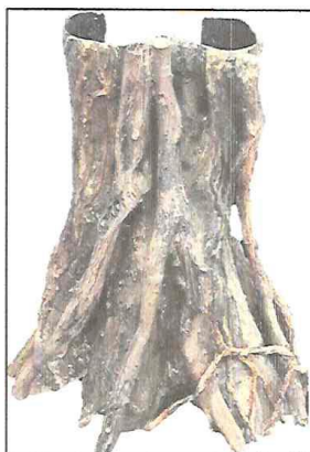
Imagen referencial: Molde de fibra de vidrio con textura de tronco de árbol
