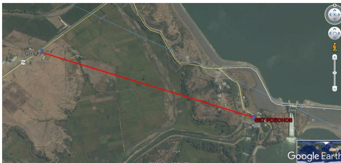
Figura 4. Ubicación de la zona del proyecto: Trazo de ruta del nuevo alimentador 19 N en 22.9 kV de la SET Poechos – Zona Sur
