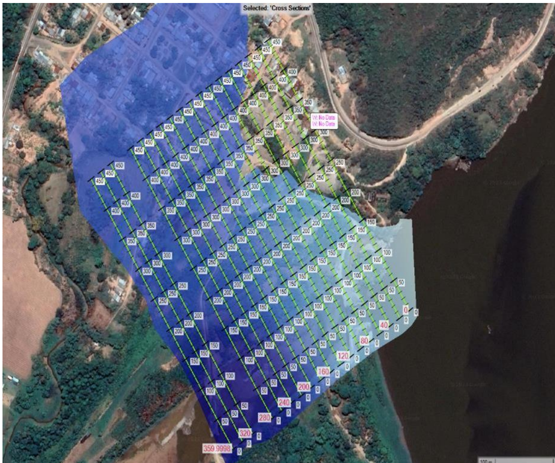
Imagen 18: Seccionamiento en planta del eje del brazo de río Huallaga.
