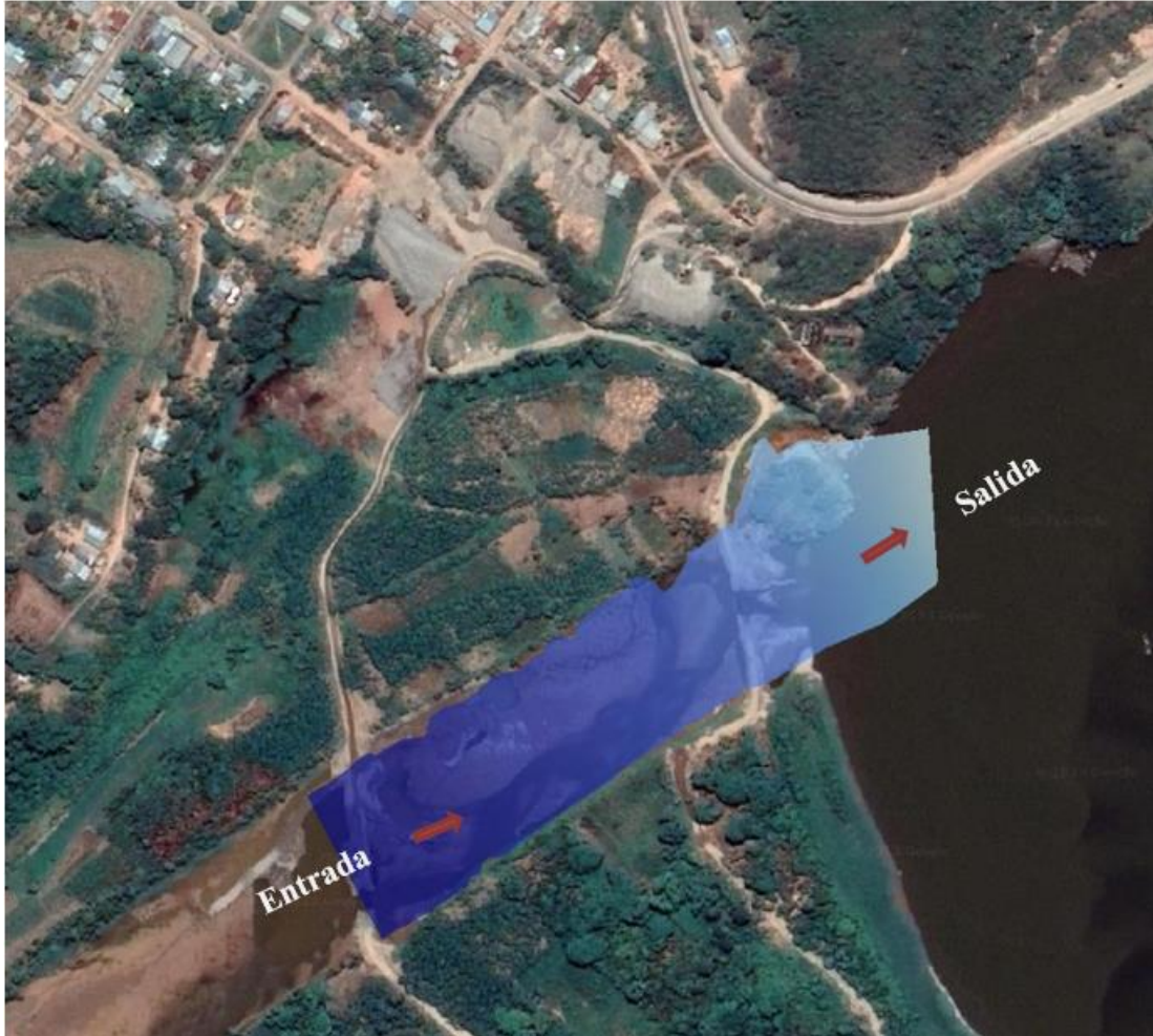
Imagen 15: Condiciones de contorno en brazo de río Huallaga (Elaboración Propia).
