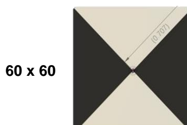
Gráfico N° 1. Modelo de señalización para los puntos de fotocontrol
