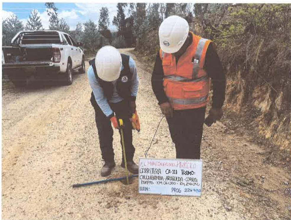
FOTO N° 68: MEDICIÓN DE ESPESOR DE AFIRMADO
