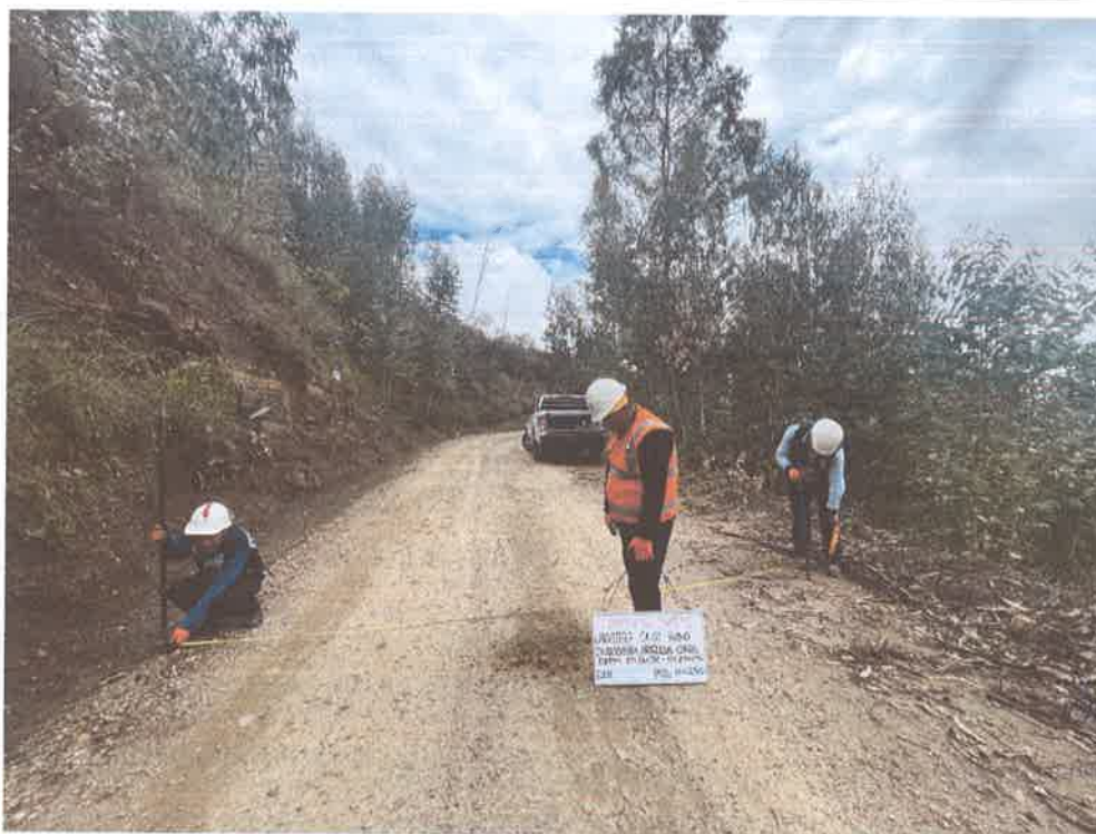
FOTO N° 46: MEDIDA DE ANCHO DE VIA
