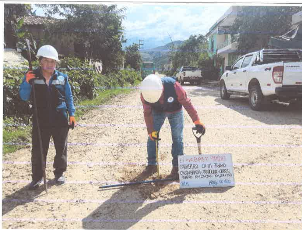
FOTO N° 02: MEDICIÓN DE ESPESOR DE AFIRMADO
