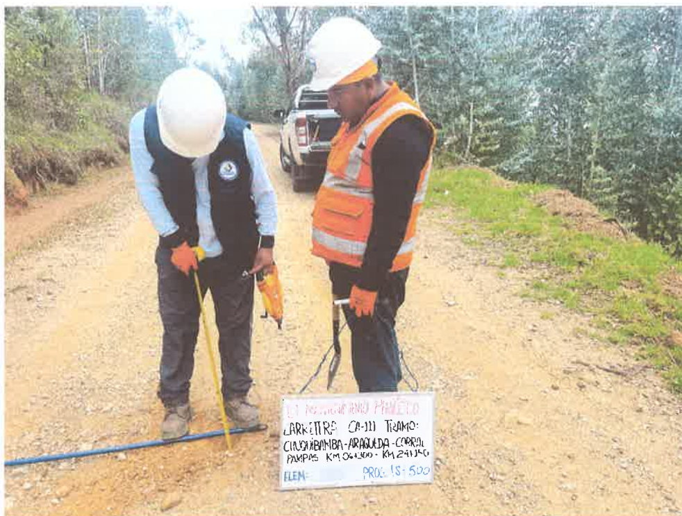
FOTO N° 51: MEDICIÓN DE ESPESOR DE AFIRMADO
