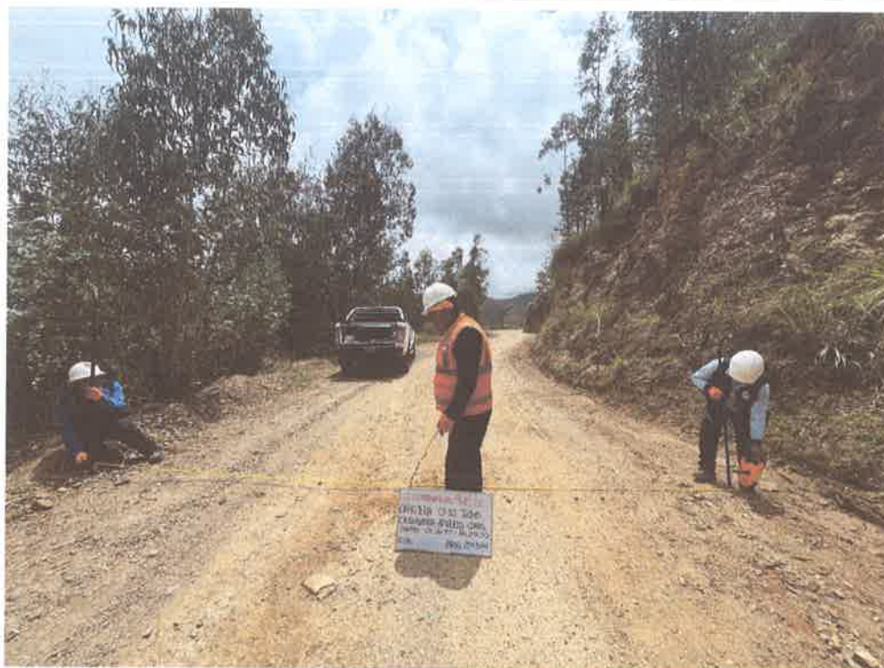
FOTO N° 59: MEDIDA DE ANCHO DE VIA
