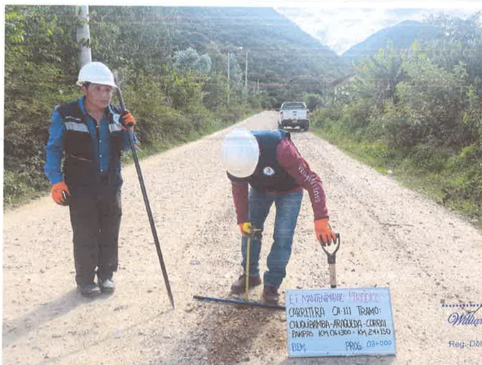
FOTO N° 08: MEDICIÓN DE ESPESOR DE AFIRMADO
