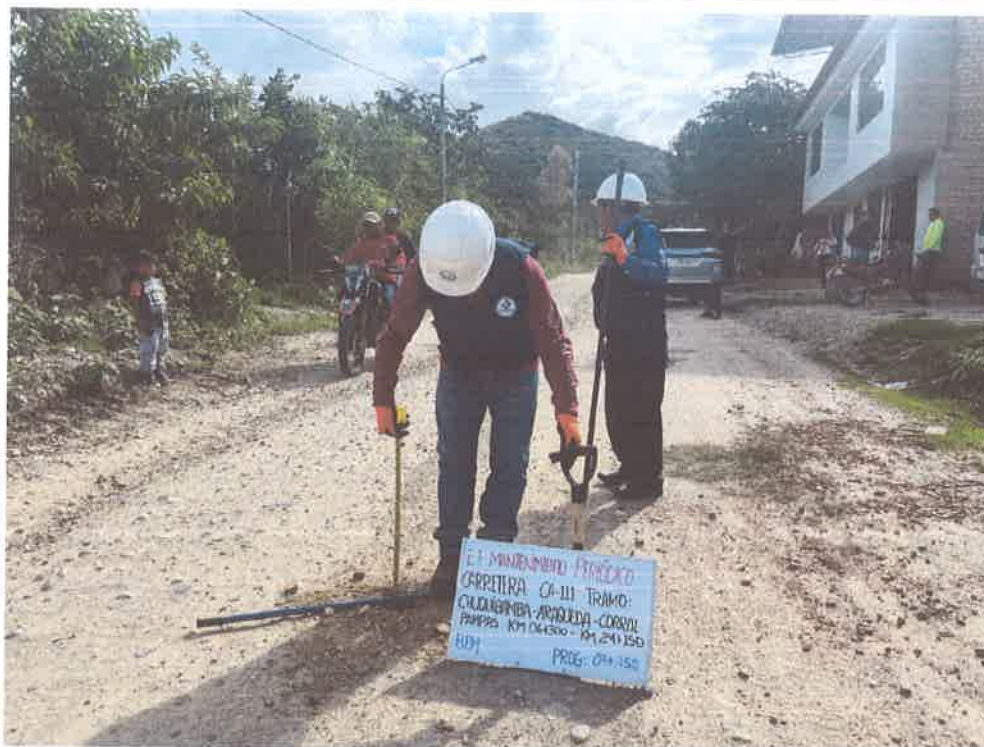
FOTO N° 07: MEDICIÓN DE ESPESOR DE AFIRMADO
