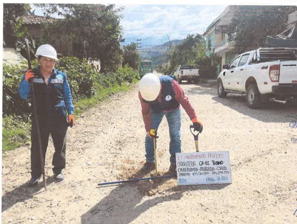
FOTO N° 02: MEDICIÓN DE ESPESOR DE AFIRMADO
