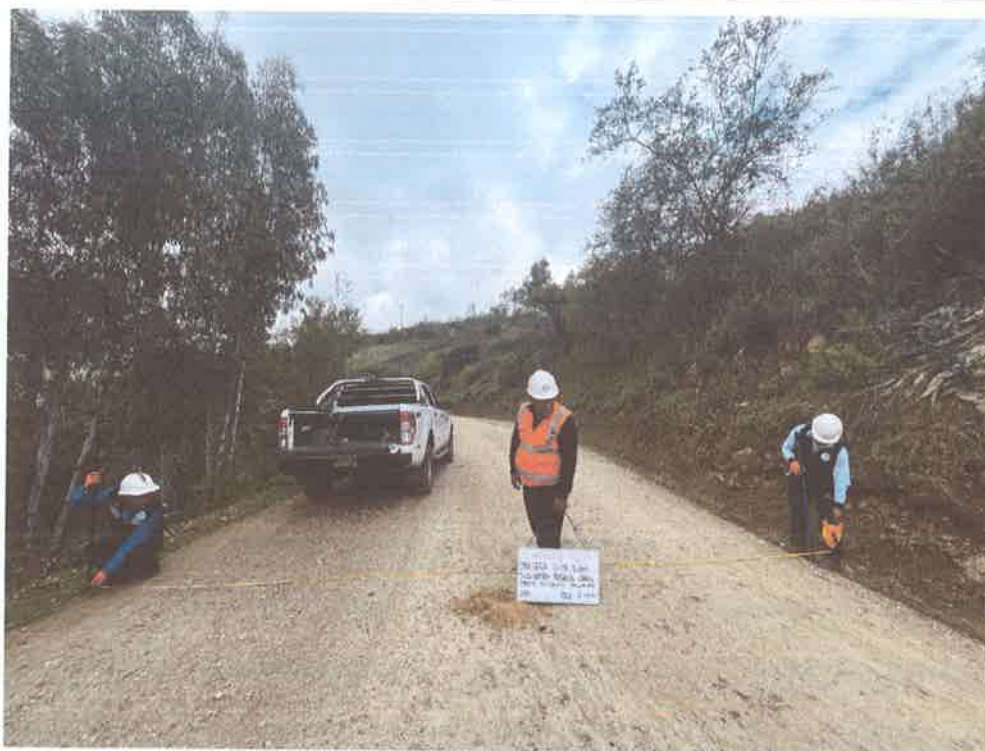
FOTO N° 41: MEDIDA DE ANCHO DE VIA
