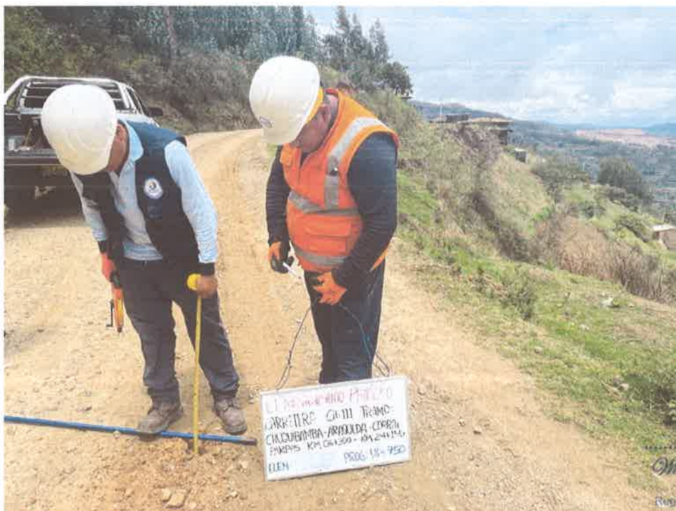
FOTO N° 52: MEDICIÓN DE ESPESOR DE AFIRMADO
