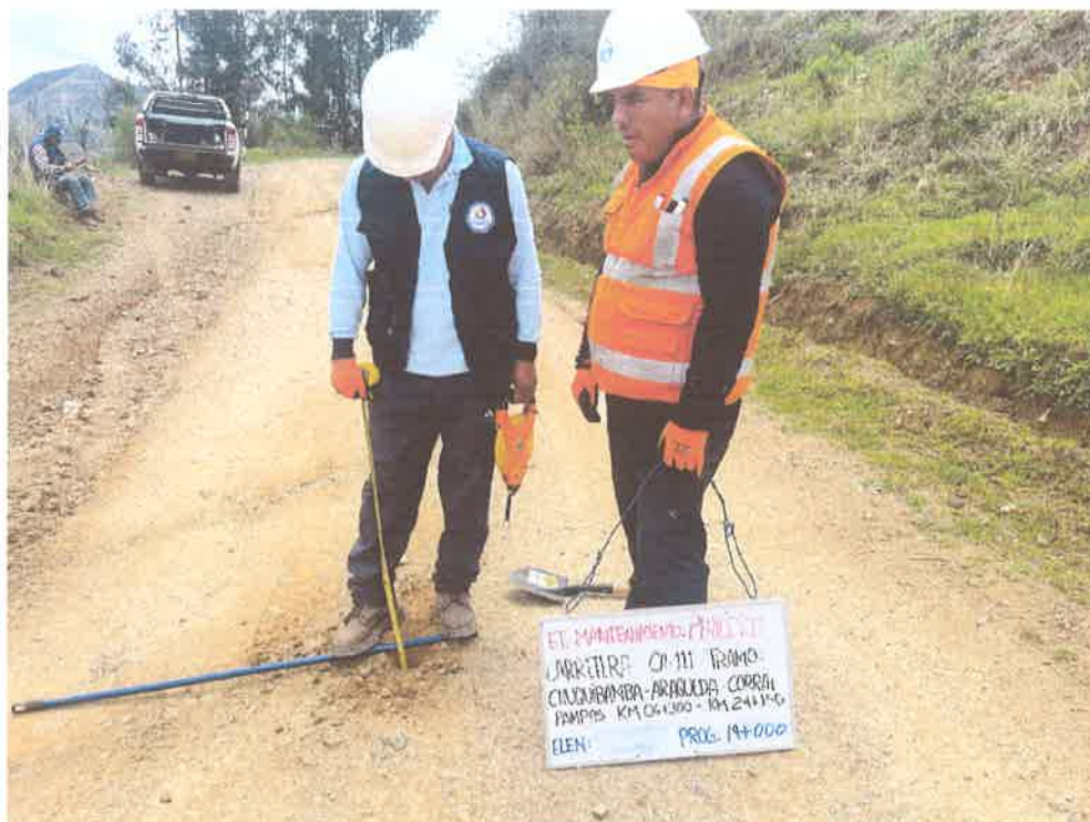
FOTO N° 53: MEDICIÓN DE ESPESOR DE AFIRMADO
