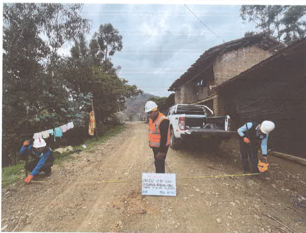
FOTO N° 36: MEDIDA DE ANCHO DE VIA
