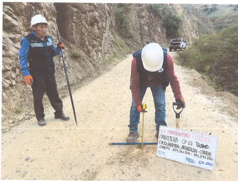
FOTO N° 17: MEDICIÓN DE ESPESOR DE AFIRMADO
