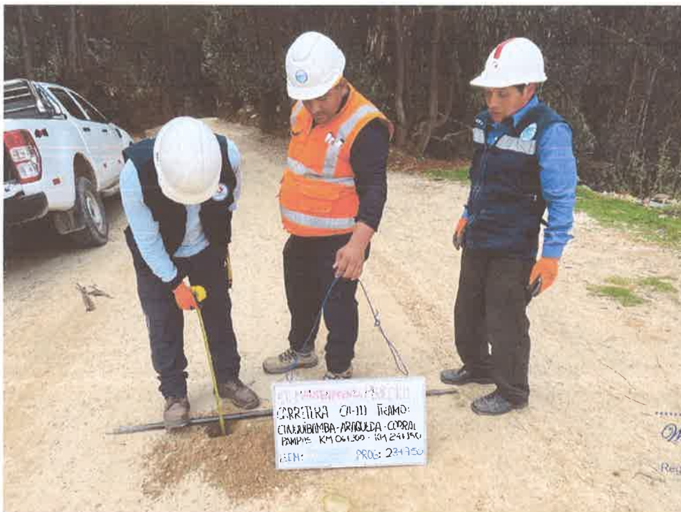
FOTO N° 72: MEDICIÓN DE ESPESOR DE AFIRMADO
