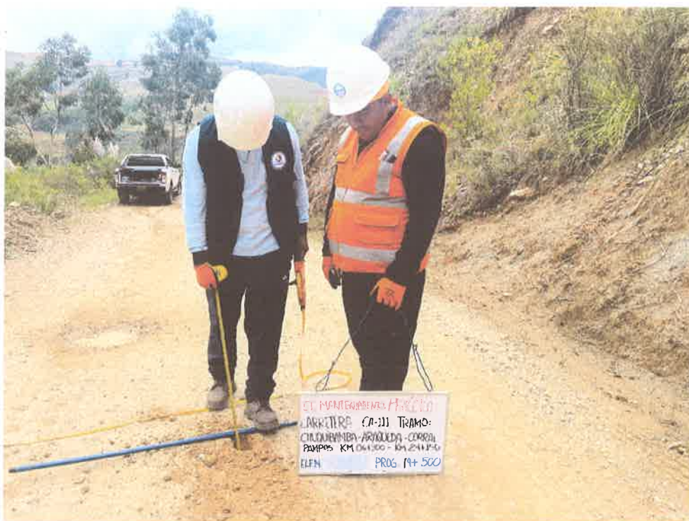
FOTO N° 55: MEDICIÓN DE ESPESOR DE AFIRMADO
