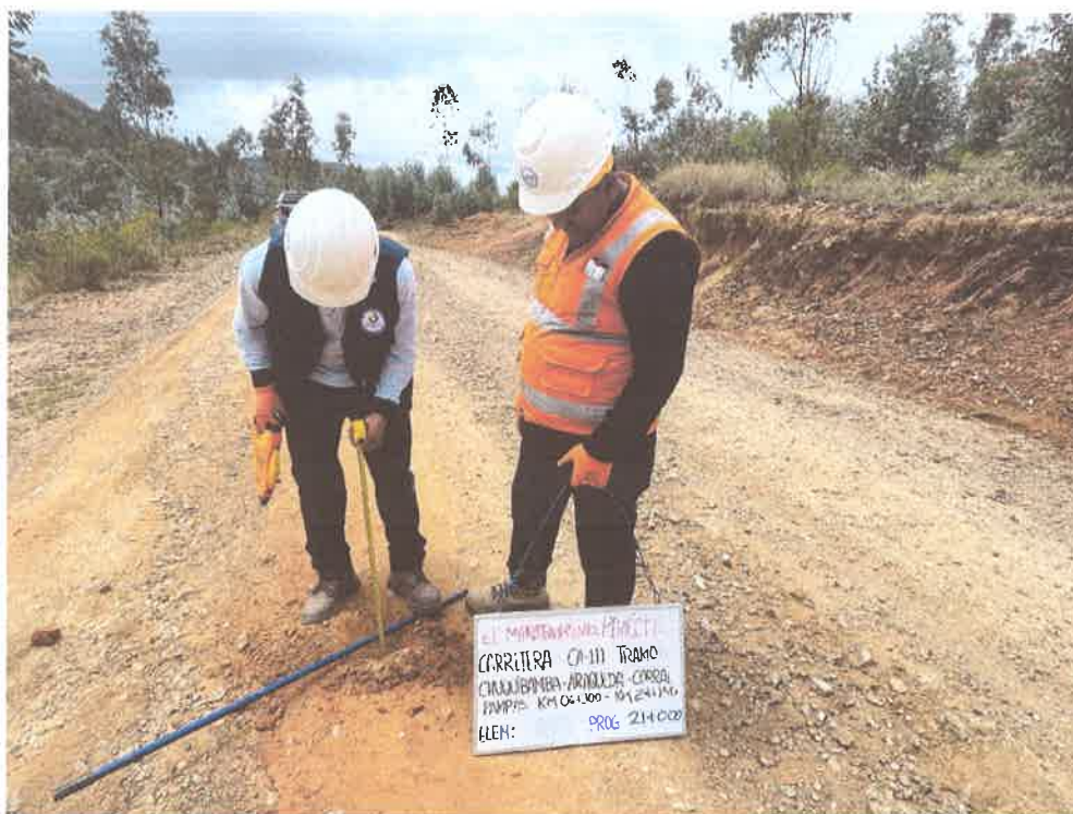
FOTO N° 61: MEDICIÓN DE ESPESOR DE AFIRMADO
