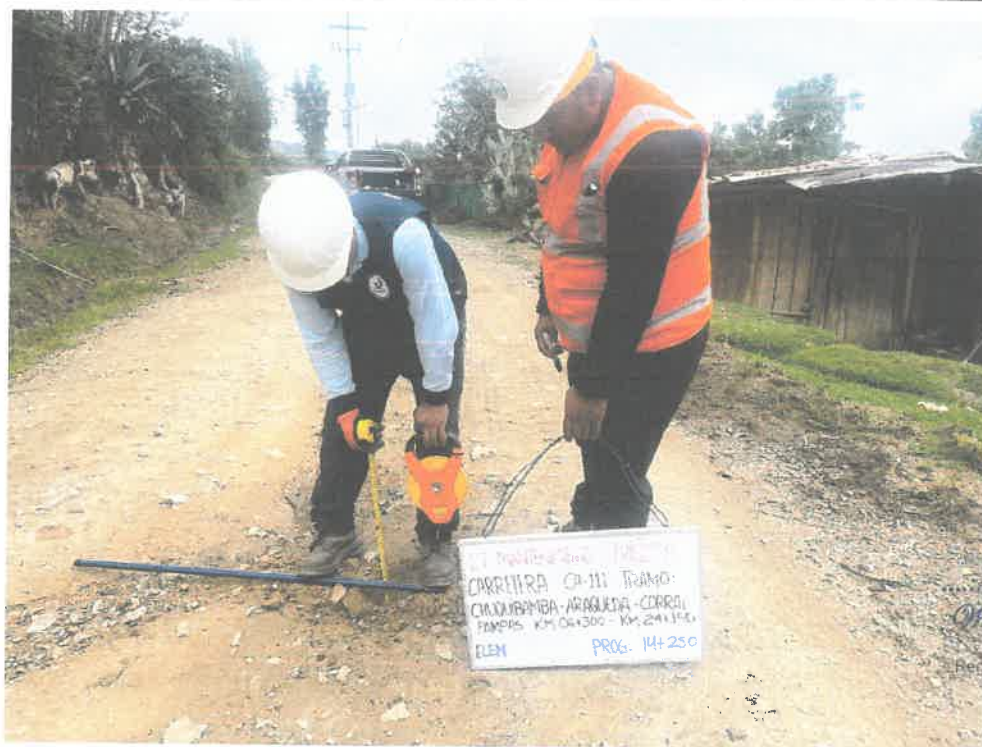
FOTO N° 34: MEDICIÓN DE ESPESOR DE AFIRMADO
