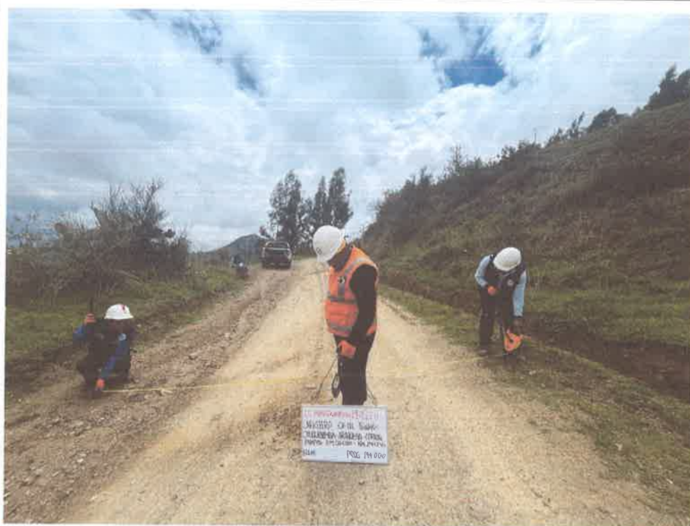
FOTO N° 53: MEDIDA DE ANCHO DE VIA
