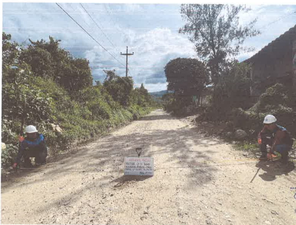
FOTO N° 04: MEDIDA DE ANCHO DE VIA
