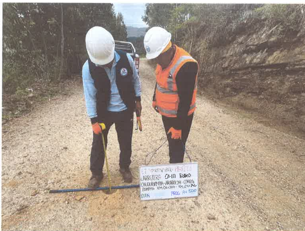
FOTO N° 47: MEDICIÓN DE ESPESOR DE AFIRMADO
