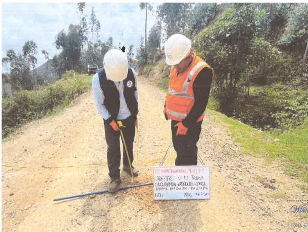
FOTO N° 54: MEDICIÓN DE ESPESOR DE AFIRMADO
