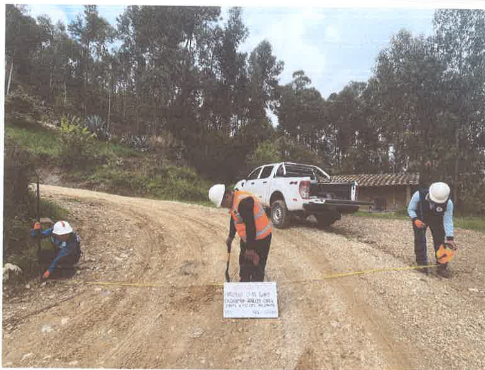
FOTO N° 31: MEDIDA DE ANCHO DE VIA
