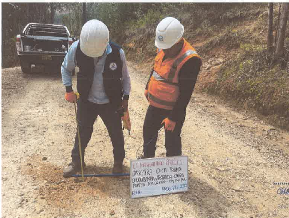
FOTO N° 50: MEDICIÓN DE ESPESOR DE AFIRMADO
