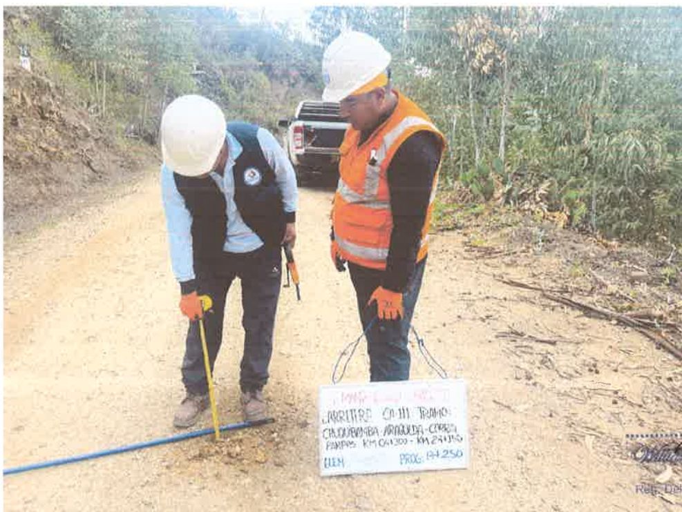
FOTO N° 46: MEDICIÓN DE ESPESOR DE AFIRMADO
