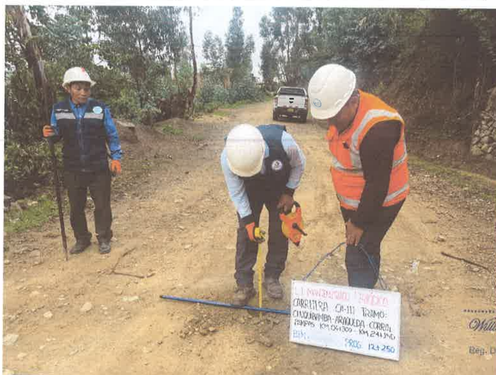
FOTO N° 24: MEDICIÓN DE ESPESOR DE AFIRMADO
