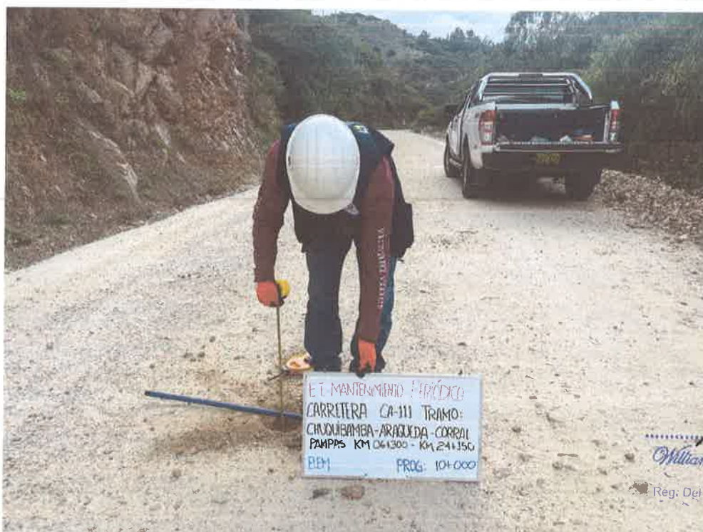
FOTO N° 16: MEDICIÓN DE ESPESOR DE AFIRMADO
