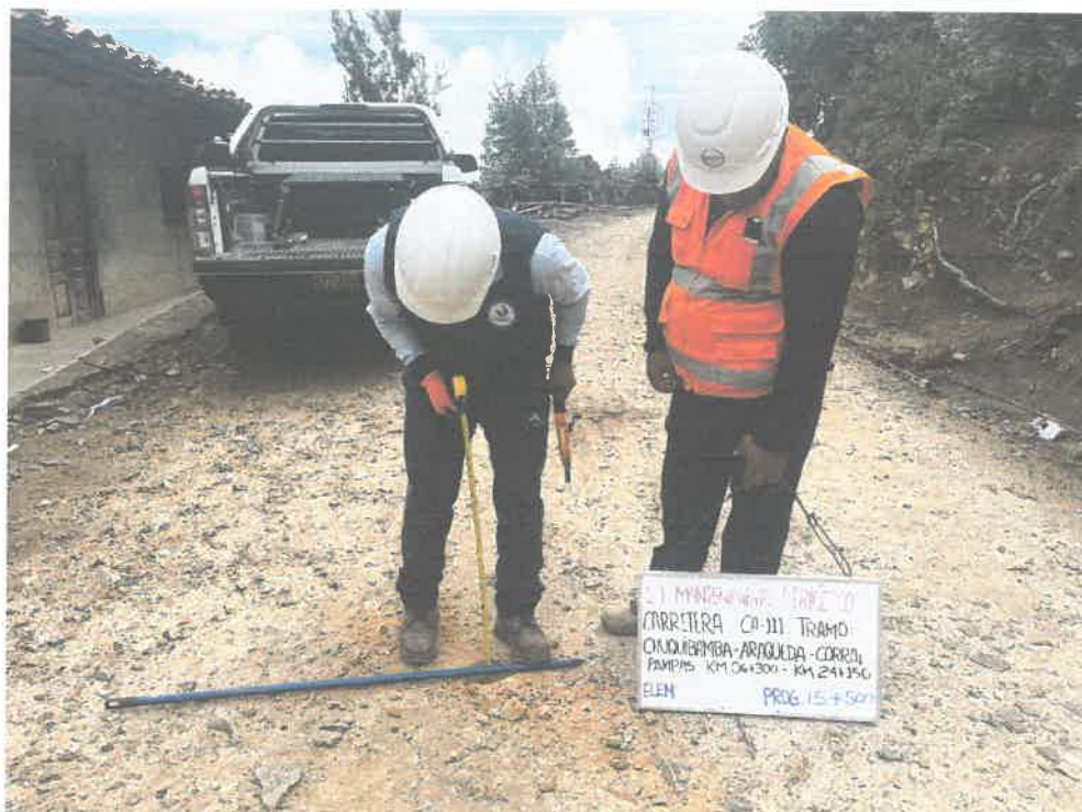
FOTO N° 39: MEDICIÓN DE ESPESOR DE AFIRMADO
