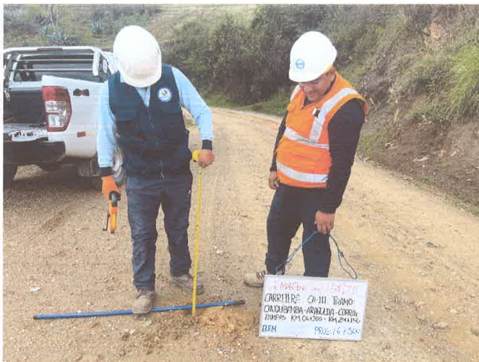
FOTO N° 43: MEDICIÓN DE ESPESOR DE AFIRMADO
