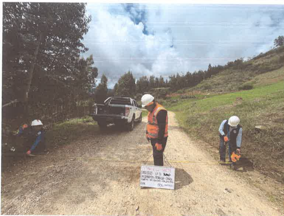
FOTO N° 45: MEDIDA DE ANCHO DE VIA
