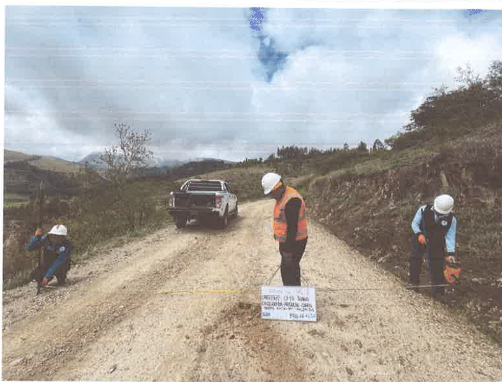
FOTO N° 42: MEDIDA DE ANCHO DE VIA
