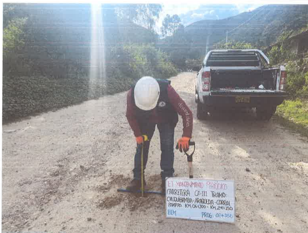
FOTO N° 11: MEDICIÓN DE ESPESOR DE AFIRMADO
