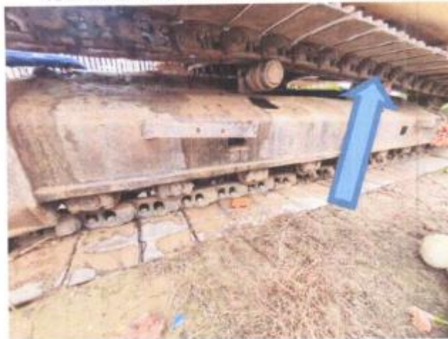
Foto N°05 Carriles Superiores en mal estado.
