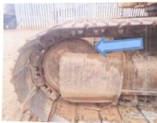
Foto N°03 Rueda guía en mal estado.
