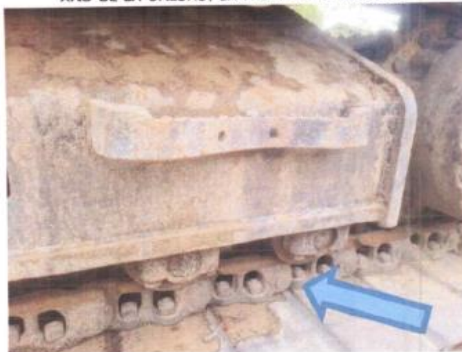
Foto N°04 Carriles Inferiores en mal estado.
