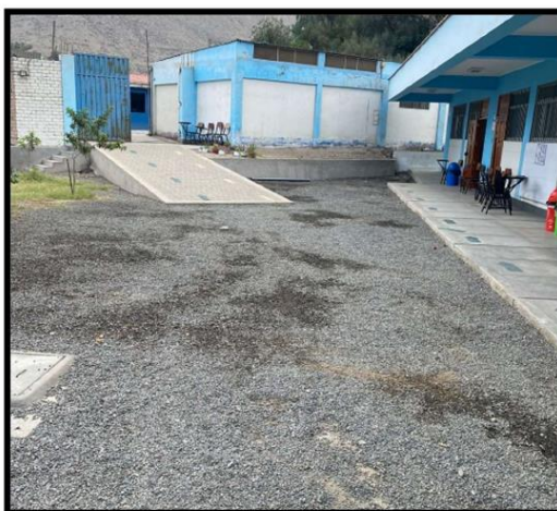
Fotografía N°03.- Desde esta ubicación se puede observar la futura modificación de la rampa, al no cumplir con la pendiente requerida para una rampa que facilite el acceso a personas con discapacidad.
