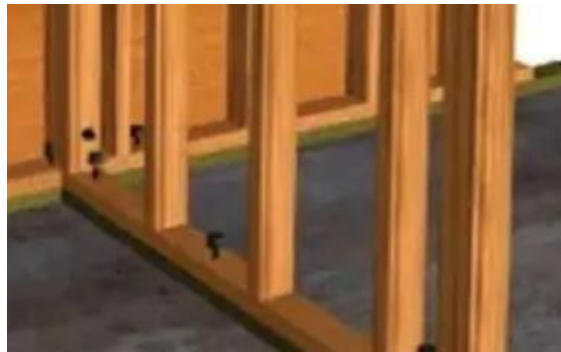
Imagen. Anclaje de tabique auto soportante a plataforma de hormigón
