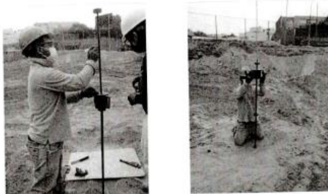
Figura 3 Ejecución de ensayos DPL
