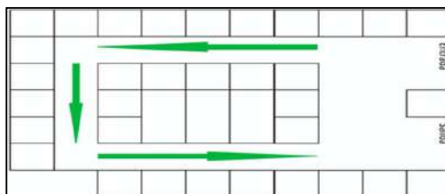
Figura 3. Flujo único, entrada y salidas únicas
