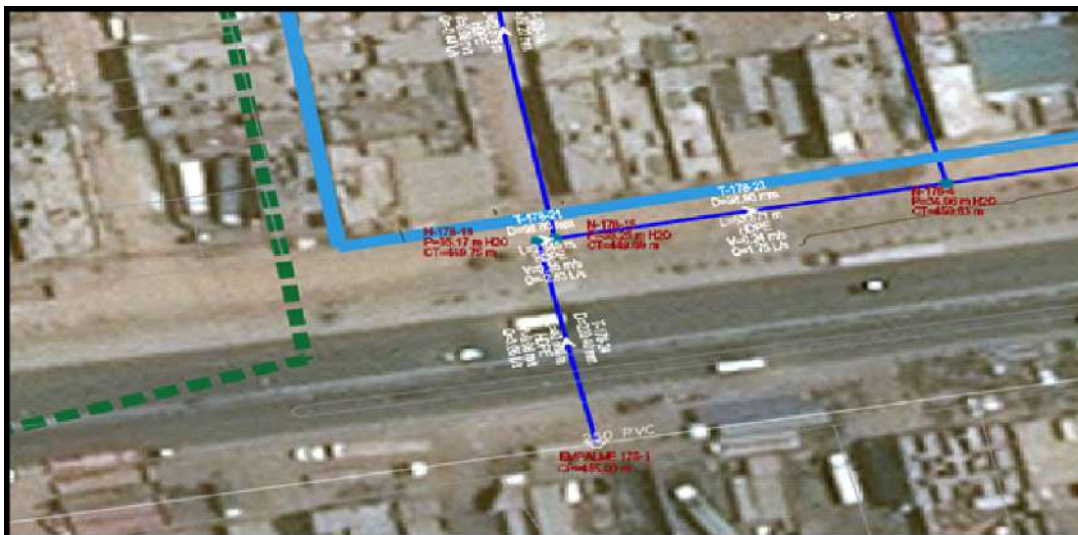
FIGURA 10.1. Cruce de 250 mm HDPE
