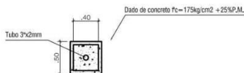
ZAPATA DE CONCRETO SIMPLE
