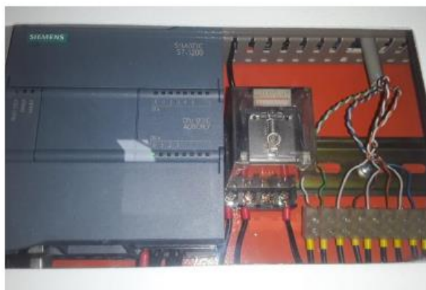
PLC instalado en el Tablero de monitoreo remoto
