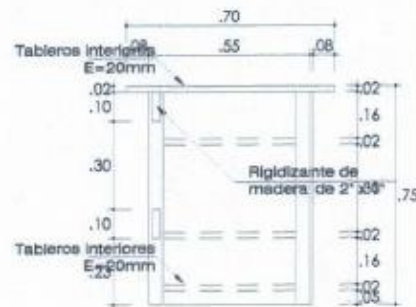
DETALLE DE CORREDERA TELESCOPICA
