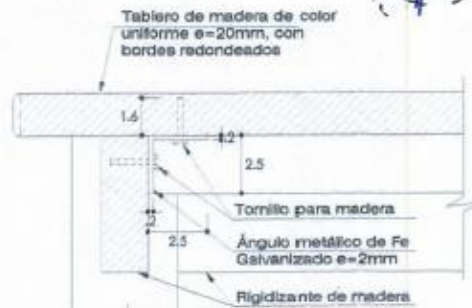
DET. 02: FIJACIÓN DE TABLERO ESC 1:2.5
