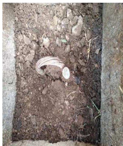
Fig. N° 13 UBICADO EN LA PARTE POSTERIOR DERECHA, PRESENTA SULFATACION
