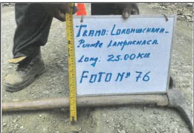
Foto 76: Espesor en pavimento de 5 cm, progresiva 05+000.
