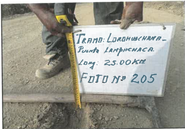
Foto 205: Espesor en pavimento de 4 cm, progresiva 13+500.
