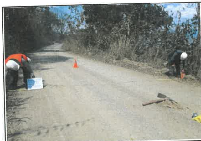
Foto 119: Ancho del pavimento de 5.70 m, progresiva 07+500.
