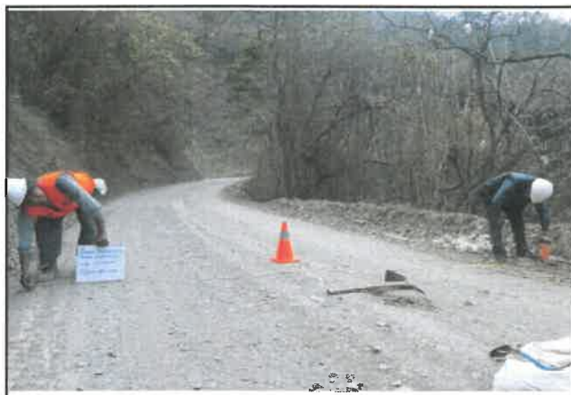
Foto 49: Ancho del pavimento de 5.00 m, progresiva 03+250.
