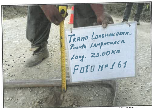
Foto 161: Espesor en pavimento de 3 cm, progresiva 10+500.
