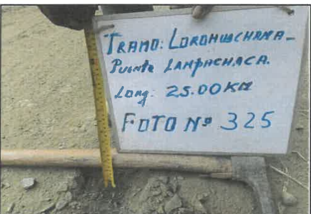
Foto 325: Espesor en pavimento de 5 cm, progresiva 21+500.
