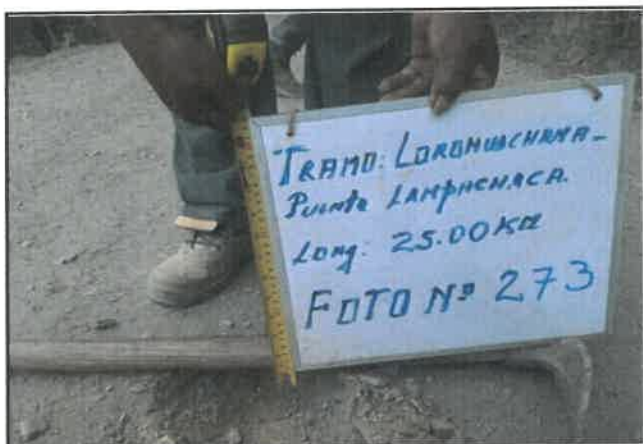
Foto 273: Espesor en pavimento de 3 cm, progresiva 18+000.
