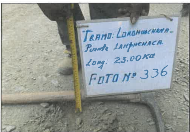
Foto 336: Espesor en pavimento de cm, progresiva 22+250.
