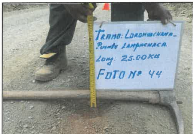
Foto 44: Espesor en pavimento de 4 cm, progresiva 03+000.
