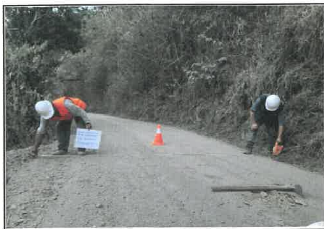
Foto 274: Ancho del pavimento de 3.70 m, progresiva 18+000.
