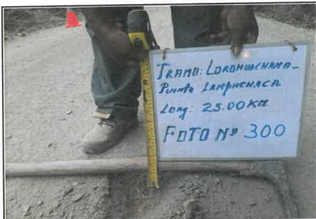
Foto 300: Espesor en pavimento de 5 cm, progresiva 19+750.
