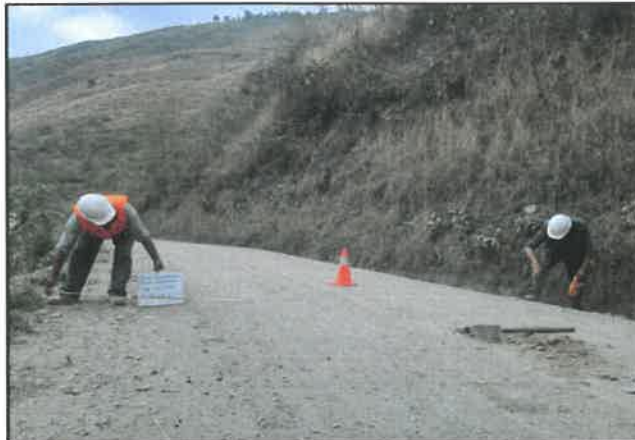
Foto 295: Ancho del pavimento de 5.00 m, progresiva 19+250.
