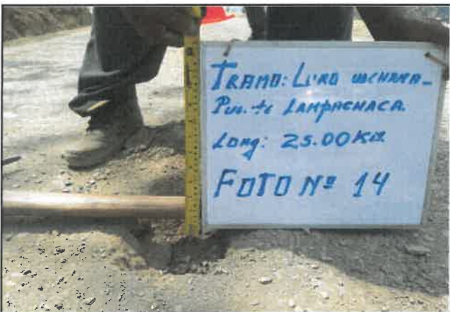
Foto 14: Espesor en pavimento de 3 cm, progresiva 01+000.
