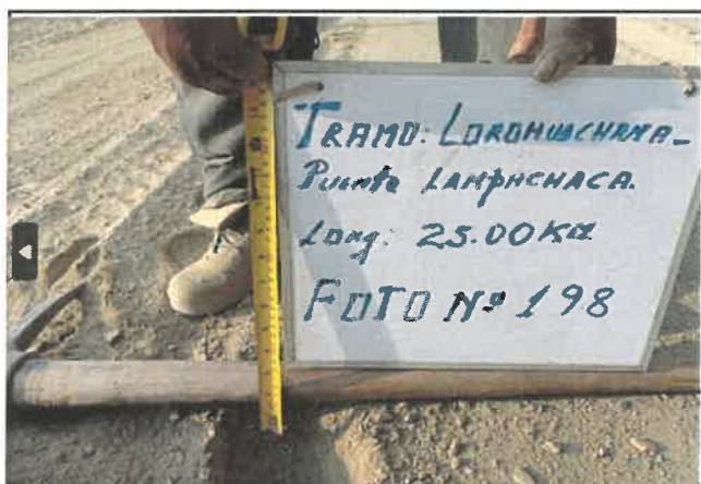
Foto 198: Espesor en pavimento de 4 cm, progresiva 13+000.
