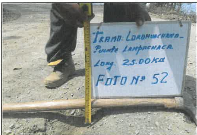
Foto 52: Espesor en pavimento de 5 cm, progresiva 03+500.
