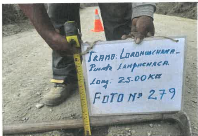
Foto 279: Espesor en pavimento de 3 cm, progresiva 18+250.
