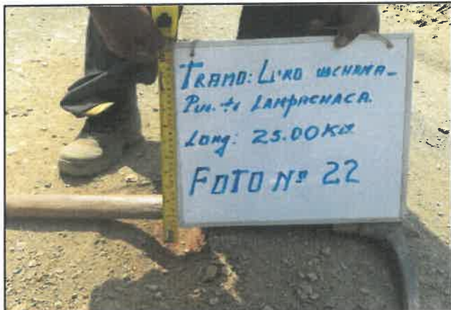
Foto 22: Espesor en pavimento de 3 cm, progresiva 01+500.
