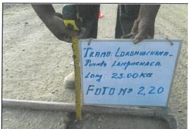
Foto 220: Espesor en pavimento de 3 cm, progresiva 14+500.
