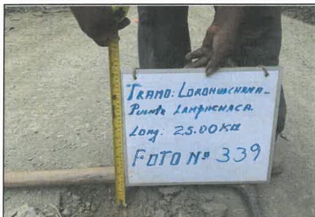
Foto 339: Espesor en pavimento de 6 cm, progresiva 22+500.
