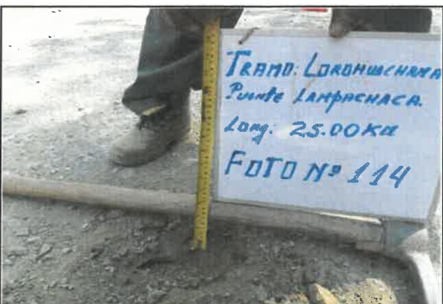
Foto 114: Espesor en pavimento de 6 cm, progresiva 07+250.
