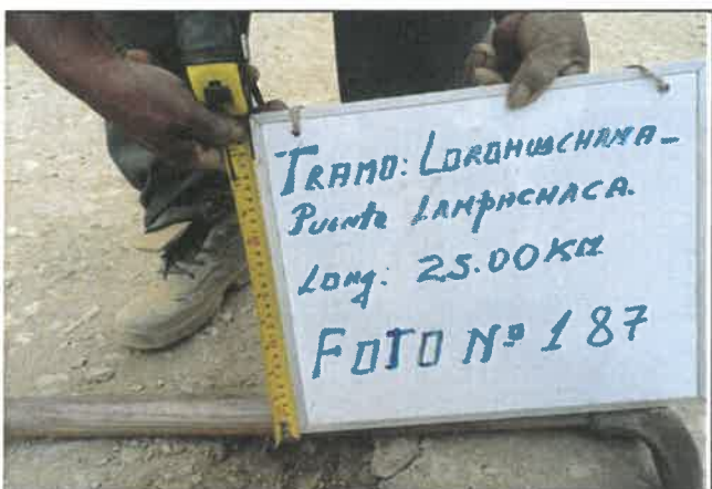
Foto 187: Espesor en pavimento de 1 cm, progresiva 12+250.
