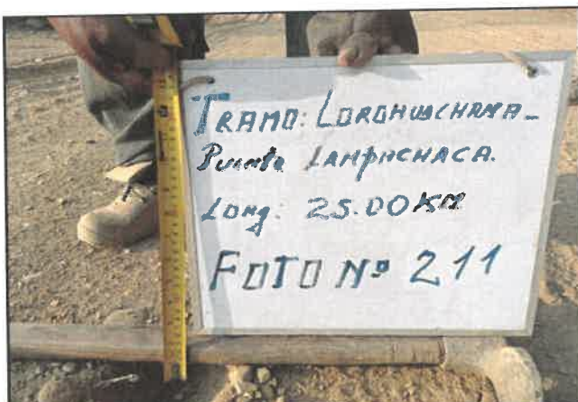
Foto 211: Espesor en pavimento de 2 cm, progresiva 14+000.
