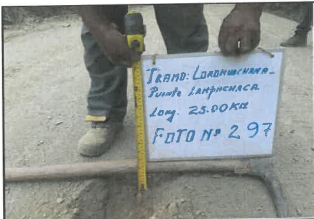
Foto 297: Espesor en pavimento de 5 cm, progresiva 19+500.
