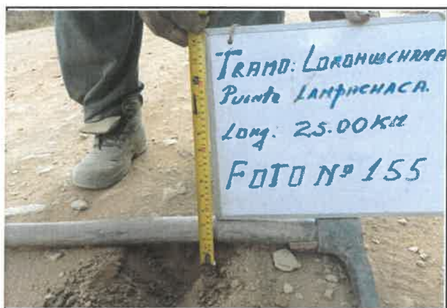
Foto 155: Espesor en pavimento de 4 cm, progresiva 10+000.
