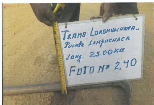
Foto 240: Espesor en pavimento de 2 cm, progresiva 16+000.
