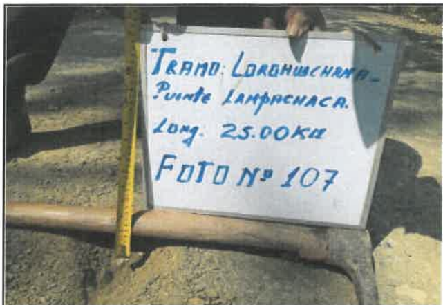
Foto 107: Espesor en pavimento de 3cm, progresiva 06+750.
