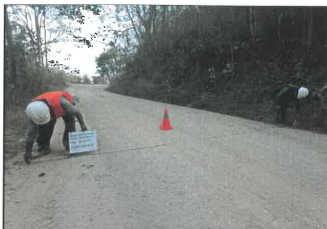
Foto 153: Ancho del pavimento de 5.30 m, progresiva 09+750.
