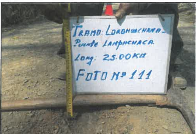
Foto 111: Espesor en pavimento de 4 cm, progresiva 07+000.
