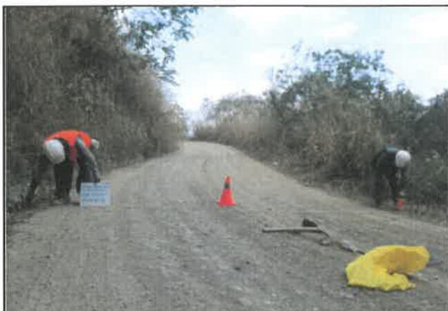
Foto 98: Ancho del pavimento de 5.50 m, progresiva 06+250.
