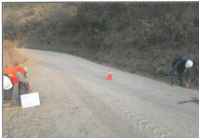
Foto 238: Ancho del pavimento de 5.60 m, progresiva 15+750.
