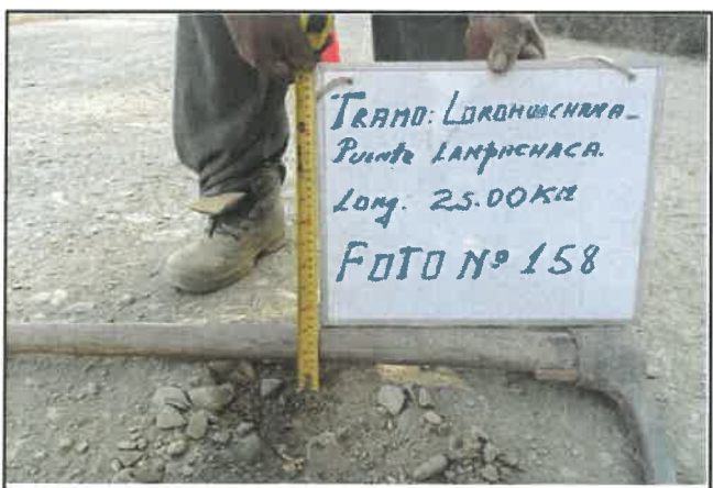
Foto 158: Espesor en pavimento de 5 cm, progresiva 10+250.
