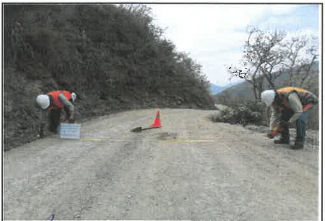
Foto 08: Ancho del pavimento de 4.80 m, progresiva 00+500.
