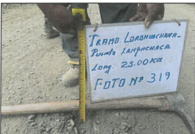
Foto 319: Espesor en pavimento de 6 cm, progresiva 21+250.
