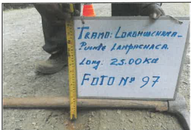
Foto 97: Espesor en pavimento de 5 cm, progresiva 06+250.
