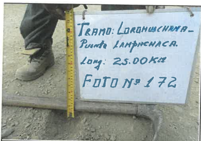
Foto 172: Espesor en pavimento de 3 cm, progresiva 11+250.
