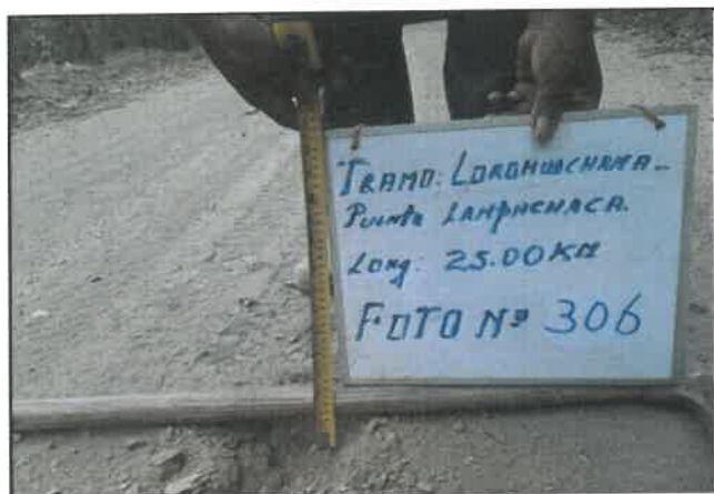
Foto 306: Espesor en pavimento de 5 cm, progresiva 20+250.
