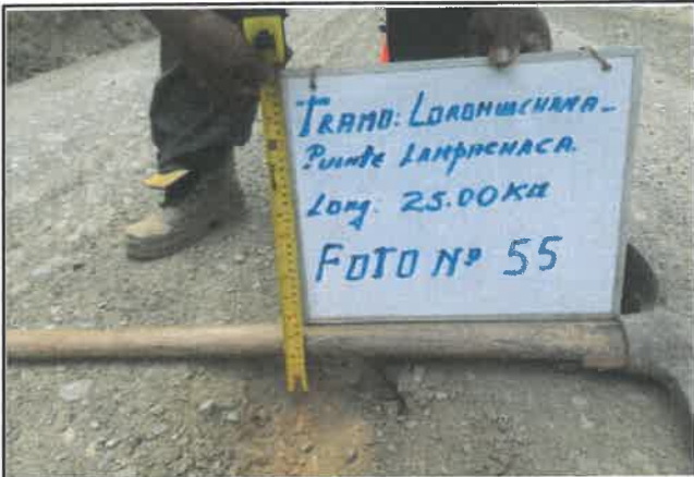
Foto 55: Espesor en pavimento de 5 cm, progresiva 03+750.
