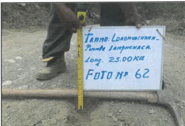
Foto 62: Espesor en pavimento de 5 cm, progresiva 04+250.
