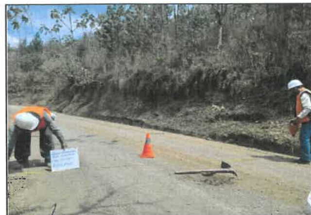
Foto 30: Ancho del pavimento de 5.00 m, progresiva 02+000.
