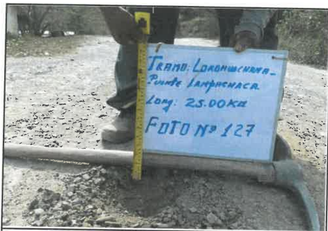
Foto 127: Espesor en pavimento de 3 cm, progresiva 08+250.
