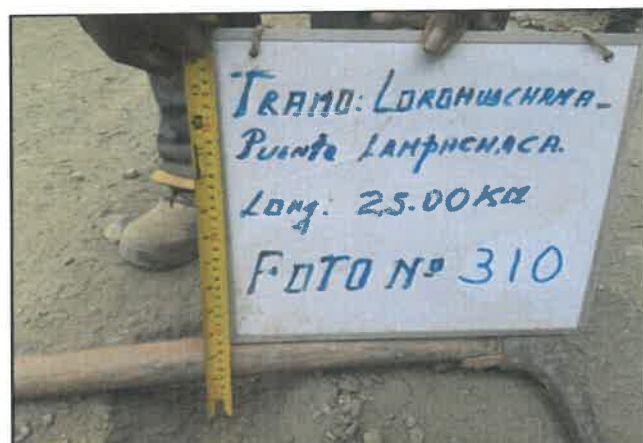
Foto 310: Espesor en pavimento de 5 cm, progresiva 20+500.
