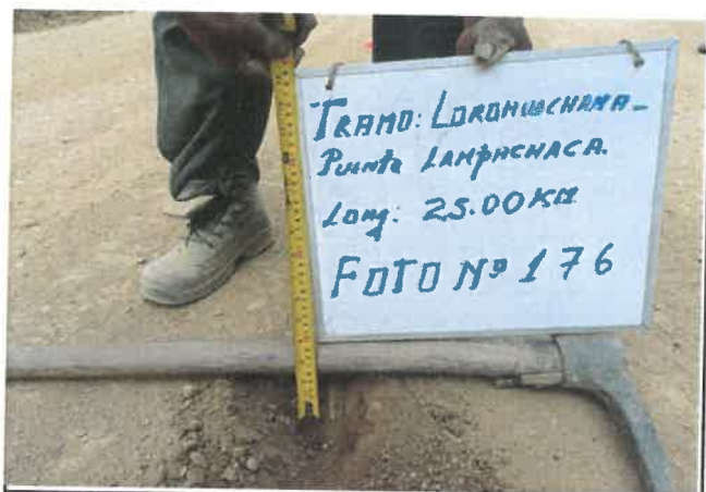
Foto 176: Espesor en pavimento de 3 cm, progresiva 11+500.
