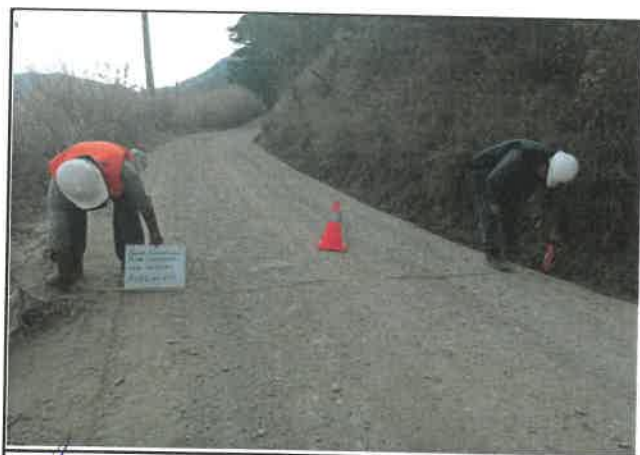
Foto 136: Ancho del pavimento de 3.50 m, progresiva 08+750.
