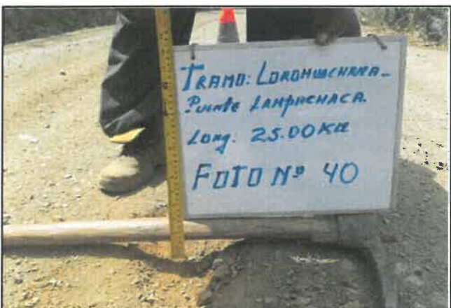
Foto 40: Espesor en pavimento de 4 cm, progresiva 02+750.
