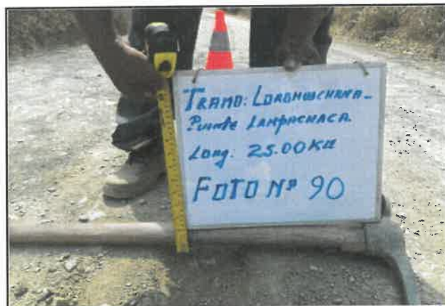
Foto 90: Espesor en pavimento de 9 cm, progresiva 05+750.
