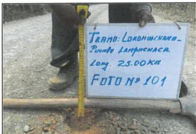
Foto 101: Espesor en pavimento de 4 cm, progresiva 06+500.
