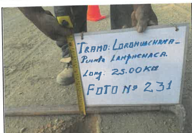
Foto 231: Espesor en pavimento de 1 cm, progresiva 15+250.
