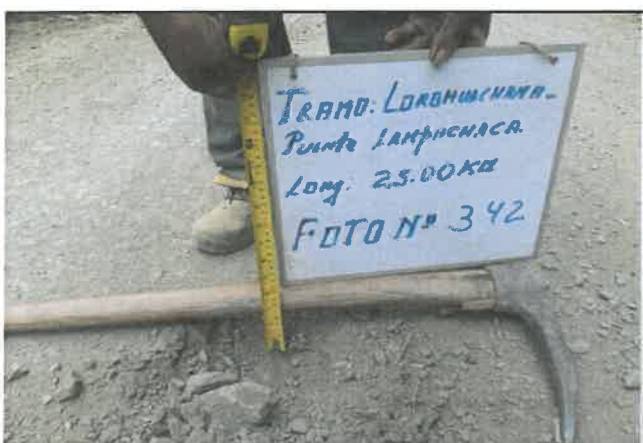
Foto 342: Espesor en pavimento de 6 cm, progresiva 22+750.
