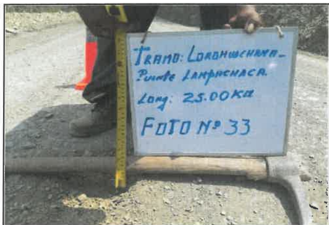
Foto 33: Espesor en pavimento de 3 cm, progresiva 02+250.
