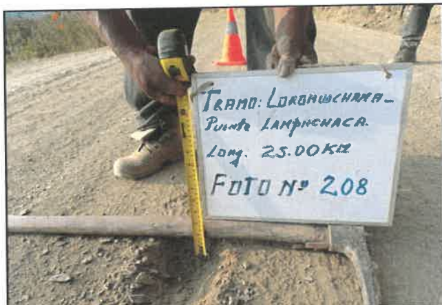
Foto 208: Espesor en pavimento de 4 cm, progresiva 13+750.
