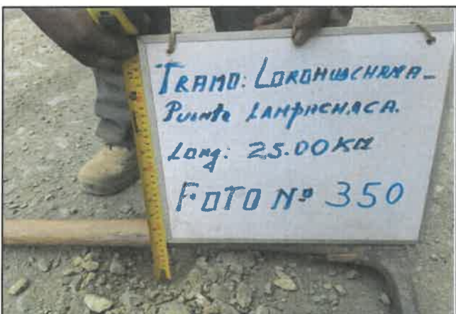
Foto 350: Espesor en pavimento de 6 cm, progresiva 23+000.
