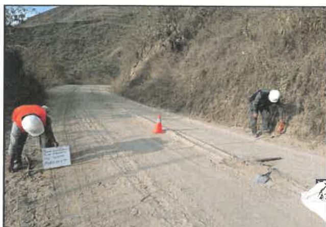
Foto 199: Ancho del pavimento de 5.00 m, progresiva 13+000.
