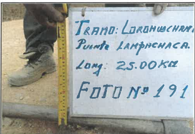
Foto 191: Espesor en pavimento de 1 cm, progresiva 12+500.
