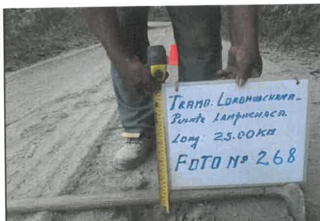
Foto 268: Espesor en pavimento de 3 cm, progresiva 17+750.
