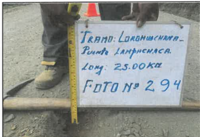
Foto 294: Espesor en pavimento de 5 cm, progresiva 19+250.
