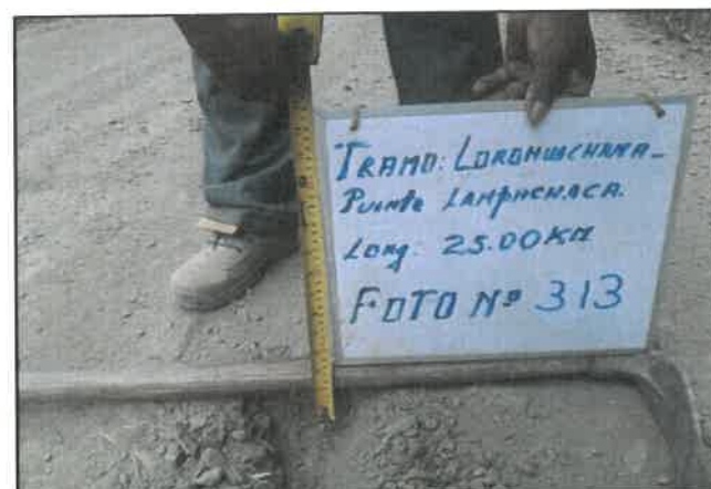
Foto 313: Espesor en pavimento de 5 cm, progresiva 20+750.
