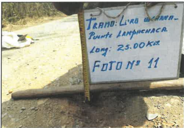
Foto 11: Espesor en pavimento de 2 cm, progresiva 00+7500.
