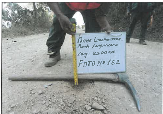
Foto 152: Espesor en pavimento de 3 cm, progresiva 09+750.
