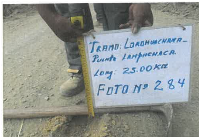
Foto 284: Espesor en pavimento de 2 cm, progresiva 18+500.
