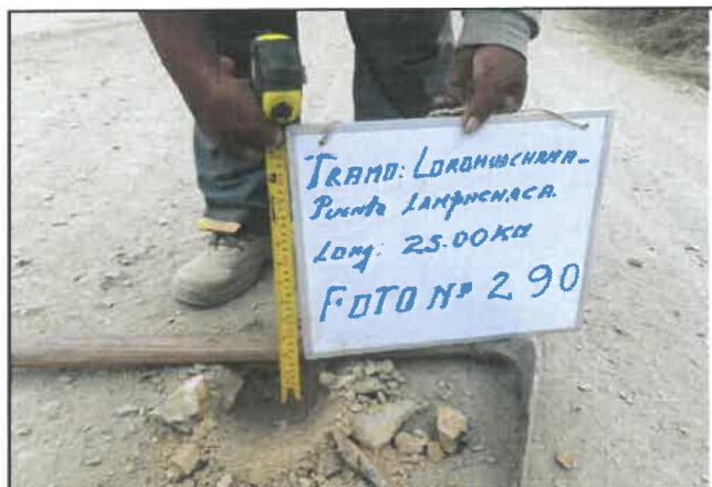
Foto 290: Espesor en pavimento de 5 cm, progresiva 19+000.
