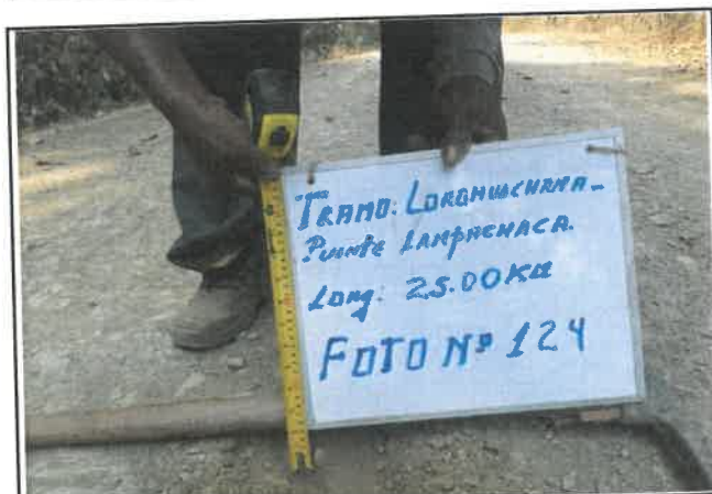
Foto 124: Espesor en pavimento de 4 cm, progresiva 08+000.
