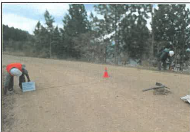
Foto 185: Ancho del pavimento de 7.20 m, progresiva 12+000.
