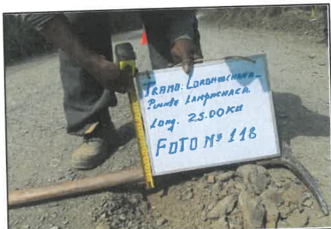
Foto 118: Espesor en pavimento de 3 cm, progresiva 07+500.
