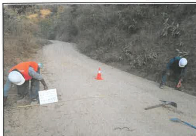
Foto 241: Ancho del pavimento de 5.70 m, progresiva 16+000.
