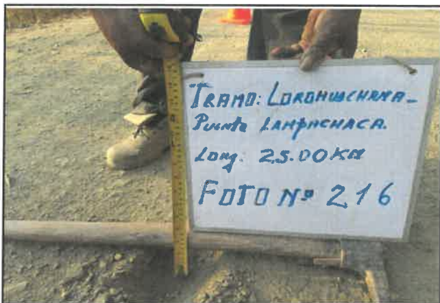
Foto 216: Espesor en pavimento de 4 cm, progresiva 14+250.
