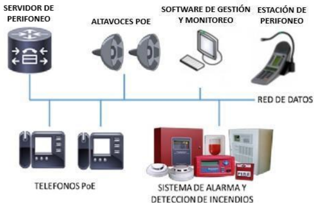
Ilustración 7: Esquema Lógico del Sistema de Sonido Ambiental y Perifoneo – Fuente Anónima
