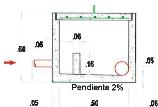
Figura 65 Sección caja de distribución de caudales – Sistema N°02
