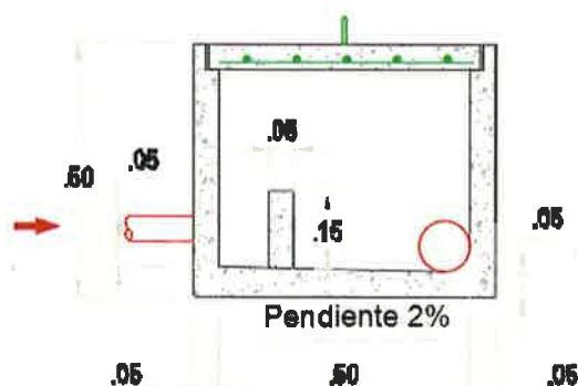
Figura 47 Sección caja de distribución de caudales
