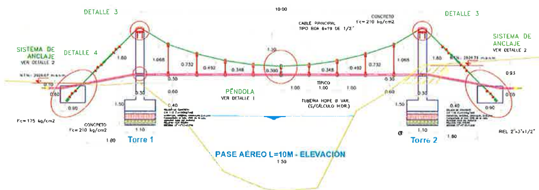
Figura 57 Pase Aéreo L=10m – Sistema Los Alisos
