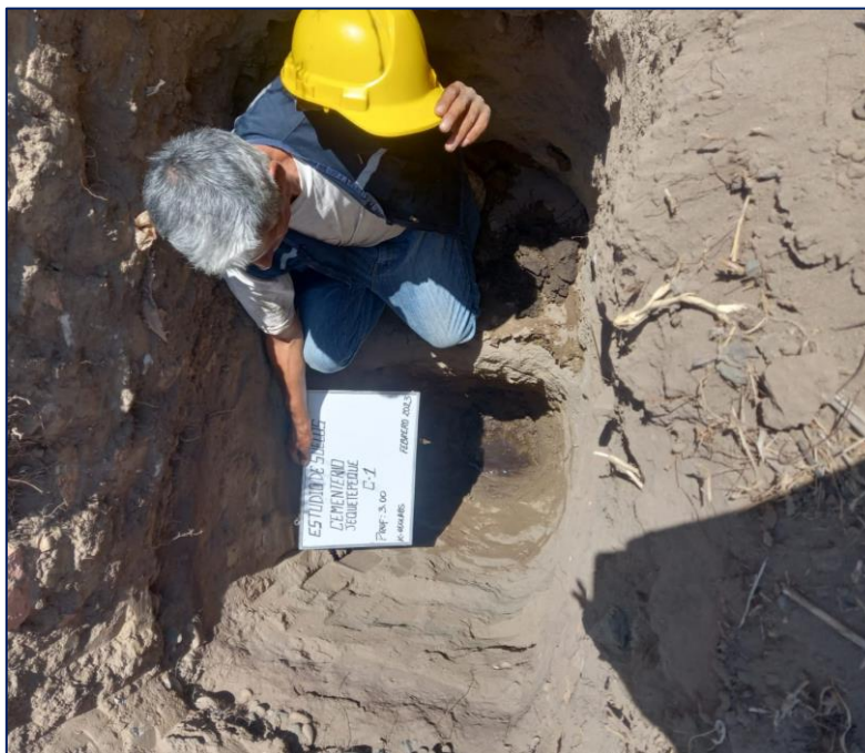
FOTO N° 2 - VISTA DE LA EXCAVACIÓN Y PERFIL DE LA CALICATA C-1.
