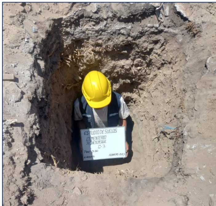
FOTO N° 6 - VISTA DE LA EXCAVACIÓN Y PERFIL DE LA CALICATA C-3.
