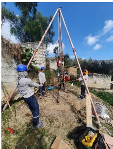
Figura 4 Ejecución del ensayo SPT
