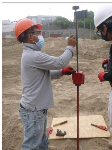
Figura 9 Ejecución de ensayos DPL
