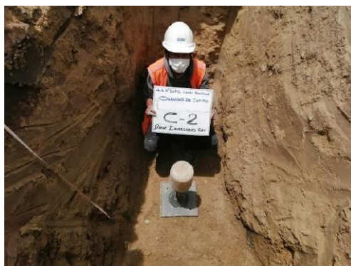
Figura 12 Personal técnico realizando el ensayo dentro de la calicata
