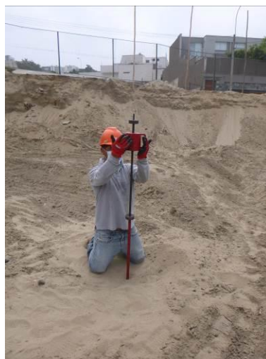
Figura 9 Ejecución de ensayos DPL
