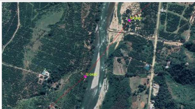
Vista del tramo E43-E44, que, en el punto más bajo del vano, no cumple con las DMS, así como la E43 se encuentra a una distancia aprox. 07 m del borde del Río Chanchamayo.
