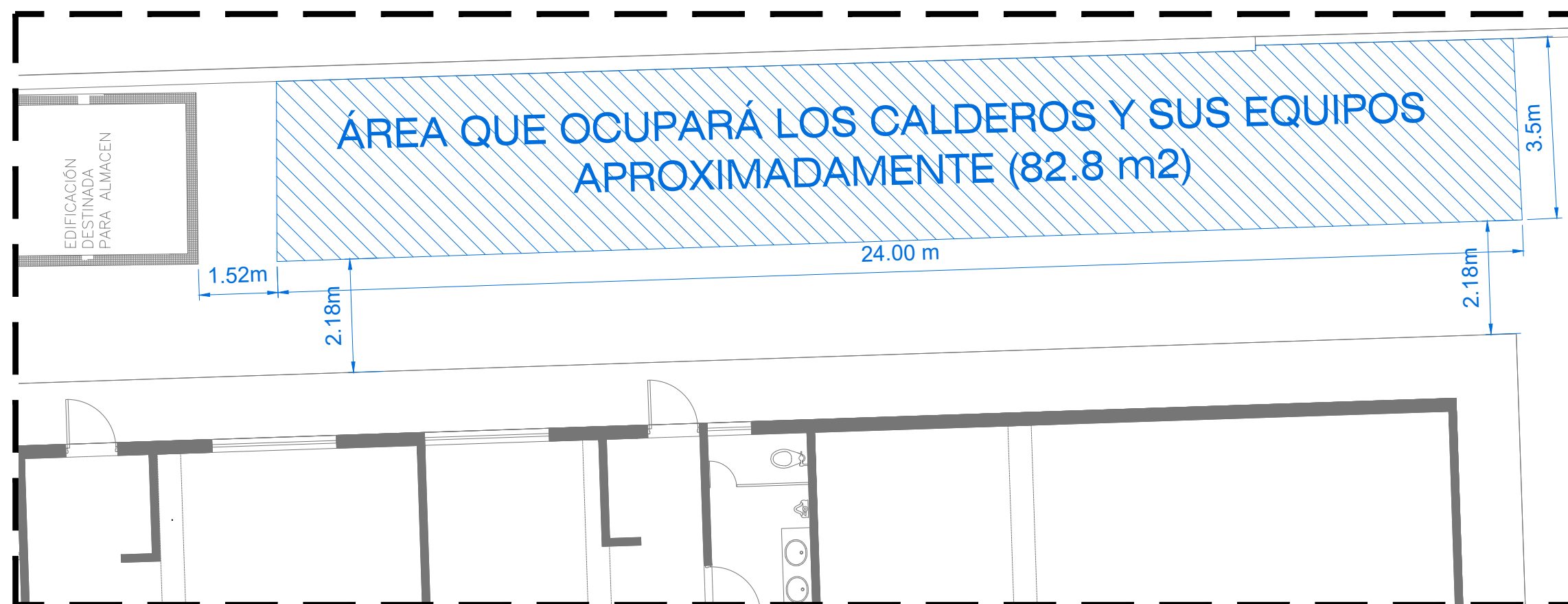
PLANTA CALDEROS - AREA DE UBICACIÓN DE CALDEROS Y EQUIPOS escala 1/100
