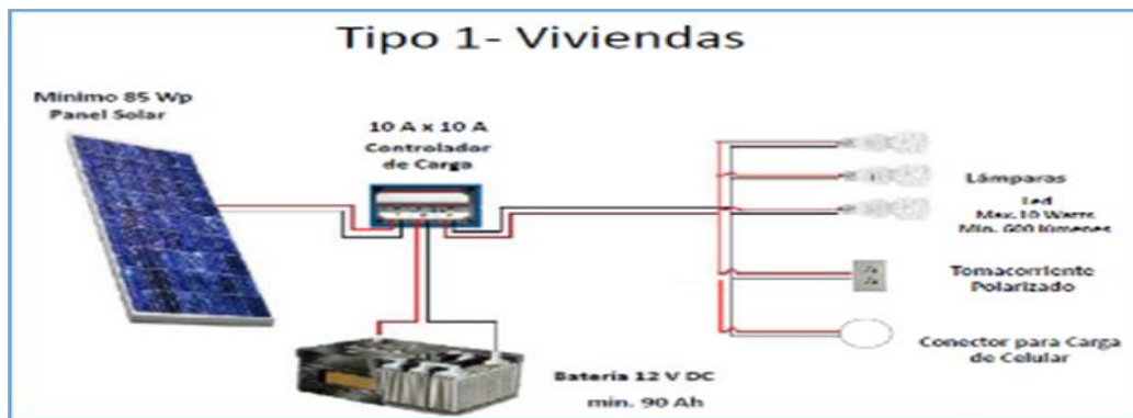
Imagen n° 01: Instalación RER Autónoma Tipo 1 – Vivienda.
