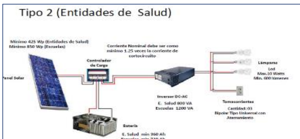
Imagen n° 02: Instalación RER Autónoma Tipo 2 – postas de salud
