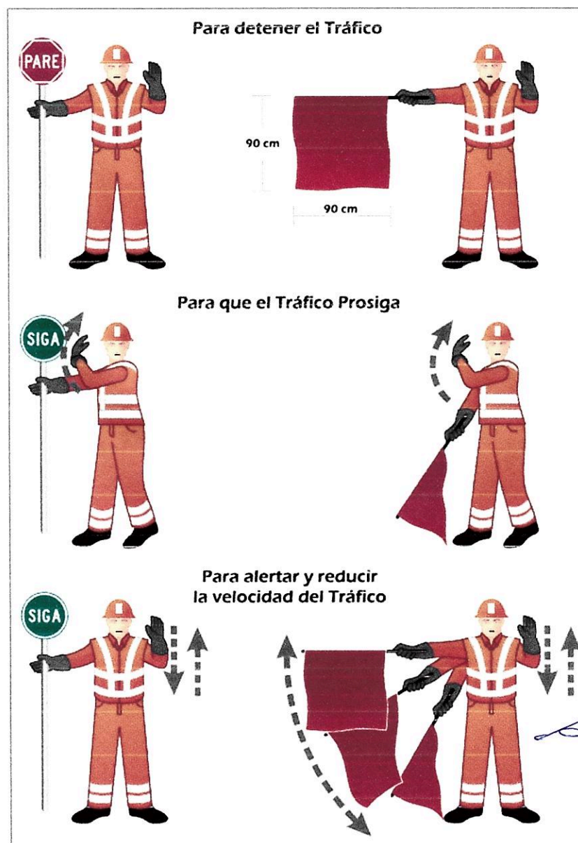
Figura 5.14 Ejemplo de "Banderilleros" con señales portátiles reglamentarias "PARE" y "SIGA", y bandera para diferentes etapas de operación vehicular en la zona de trabajo
