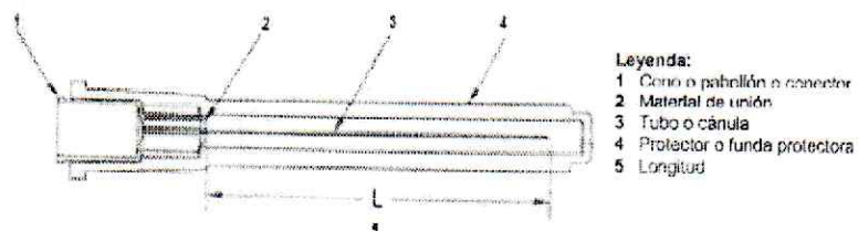
Figura referencial N° 4: Representación esquemática de una aguja hipodérmica y protector típico, para un solo uso
