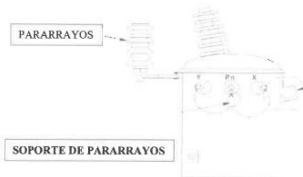
Figura 01.- Soporte de pararrayos en transformador
