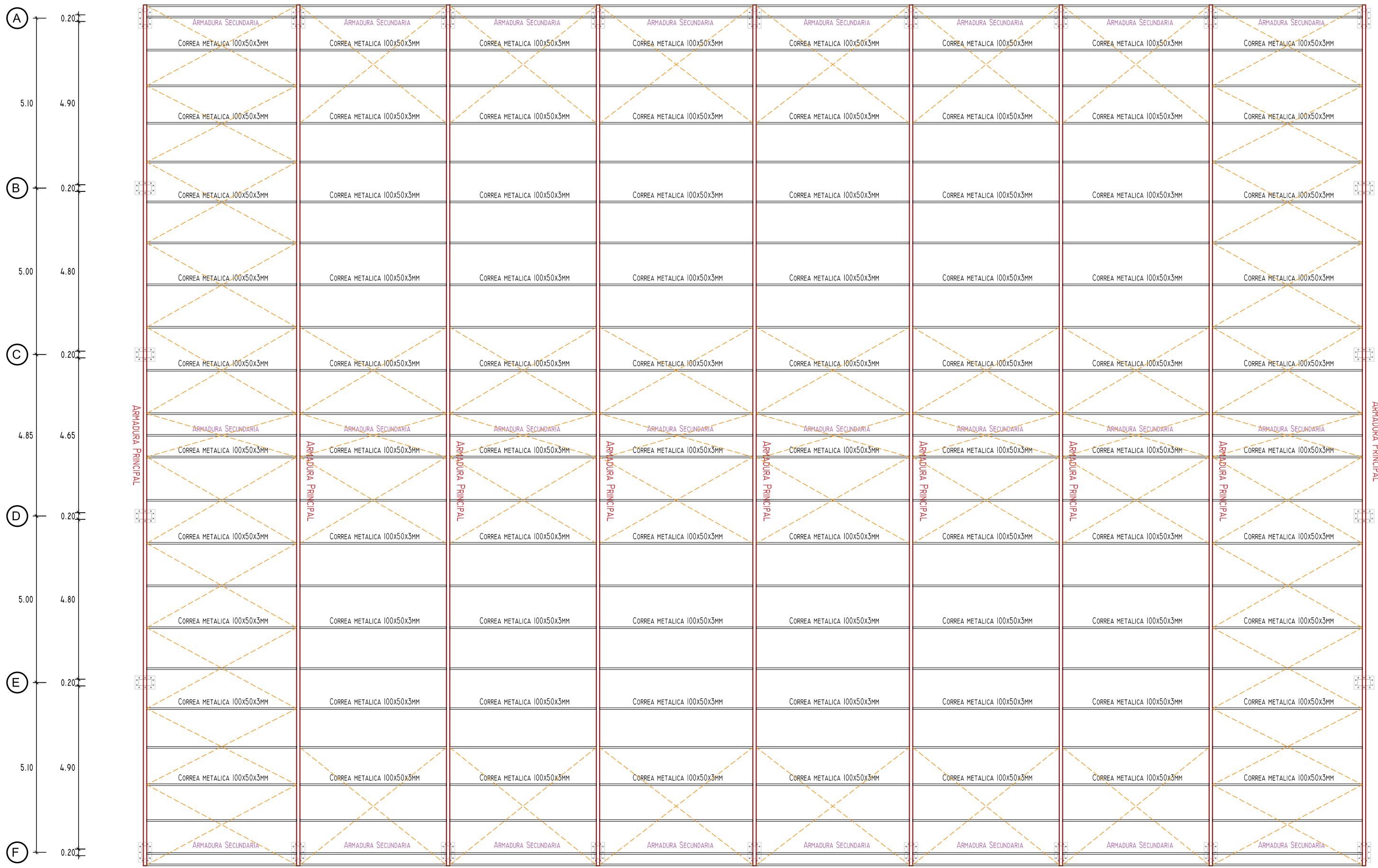
DISTRIBUCION DE ARMADURAS Y ARRIOSTRES ESCALA: 1/75
