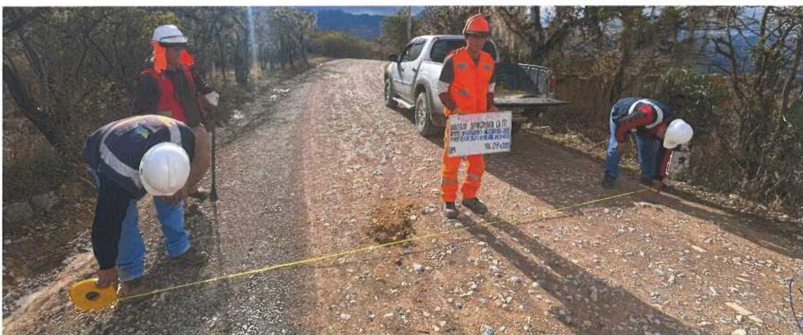
Fotografía N° 29: Medidas de superficie de rodadura, Progresivas 09+000
