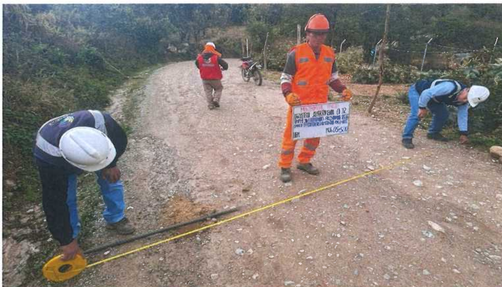
Fotografía N° 15: Medidas de superficie de rodadura, Progresivas 05+500
