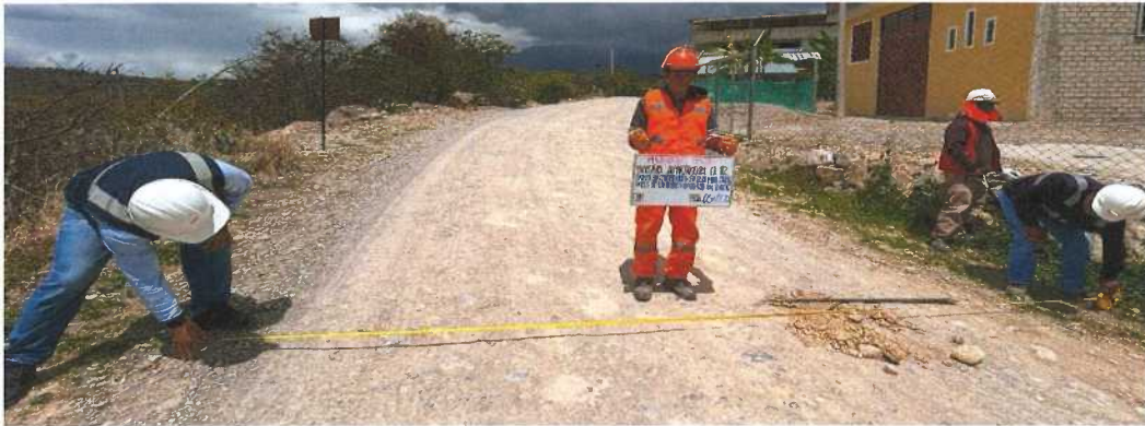
Fotografía N° 13: Medidas de superficie de rodadura, Progresivas 05+000
