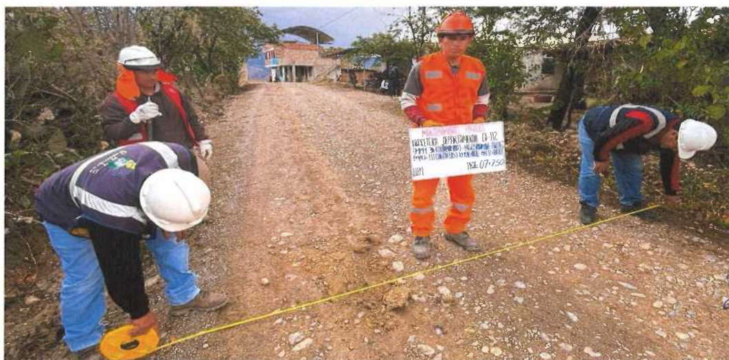
Fotografía N° 24: Medidas de superficie de rodadura, Progresivas 07+750
