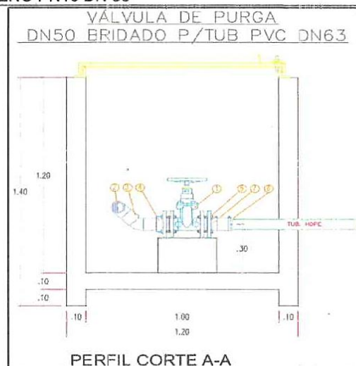
CUADRO N°11: DESPIECE DE MATERIALES VÁLVULA DE PURGA PVC 63MM
