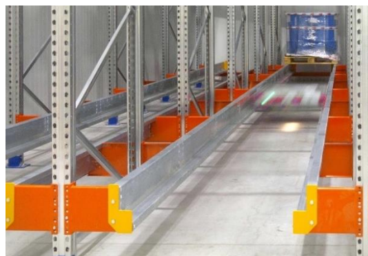
• Figura 1: Imagen Referencial de Sistema de racks acumulativos
