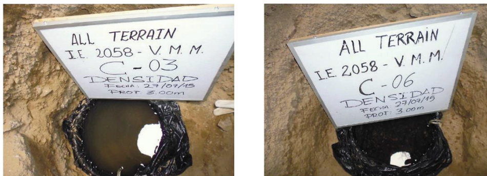
Figura 10 Ejecución de ensayo reemplazo de agua
