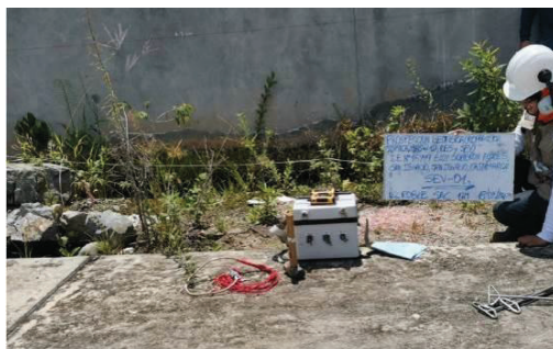
Figura 17 Ejecución de sondaje eléctrico vertical
