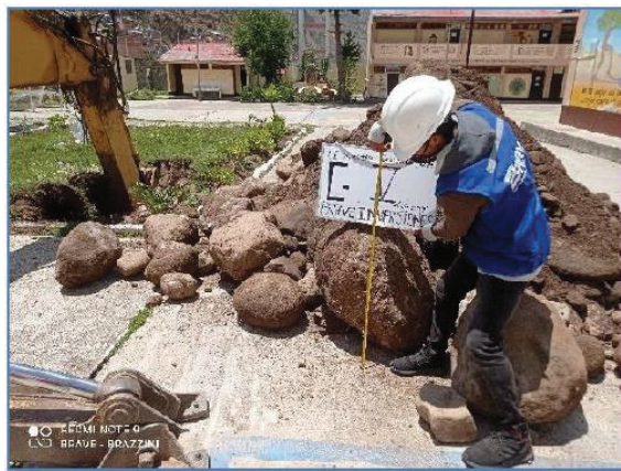
Figura 2 Boleos extraídos en la calicata C-V
