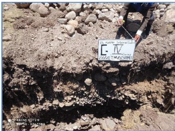
Figura 1 Perfil estratigráfico en la calicata C-IV
