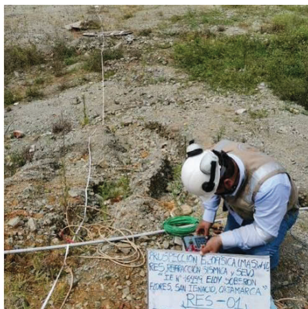
Figura 16 Ejecución de tomografía eléctrica
