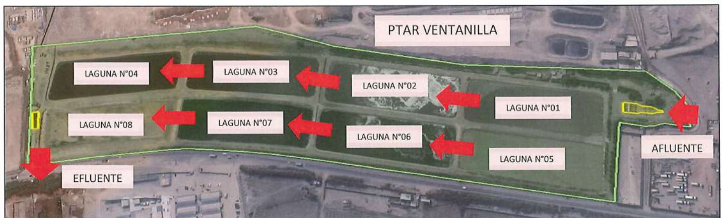
Figura n°02: Configuración hidráulica de la PTAR Ventanilla
