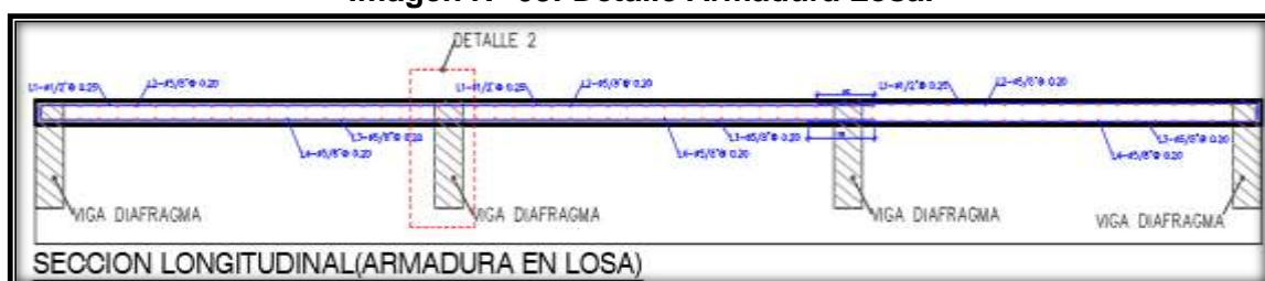
Imagen N° 03: Detalle Armadura Losa.
