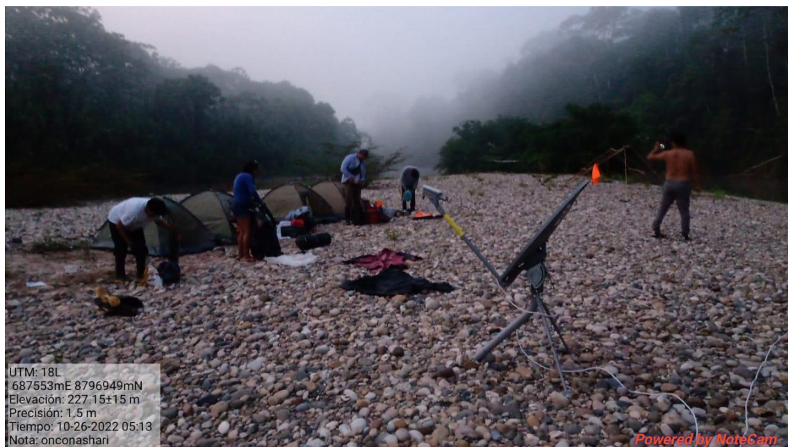
Foto Nº 03 – Rio Sepa rumbo a CCNN Onconashari enero 2023: Internet Satelital Portátil de la empresa SIGT utilizadas para el envío de datos de data de GPS, para correcciones a tiempo real(Hughesnet) https://www.hughesnet.com.pe/
