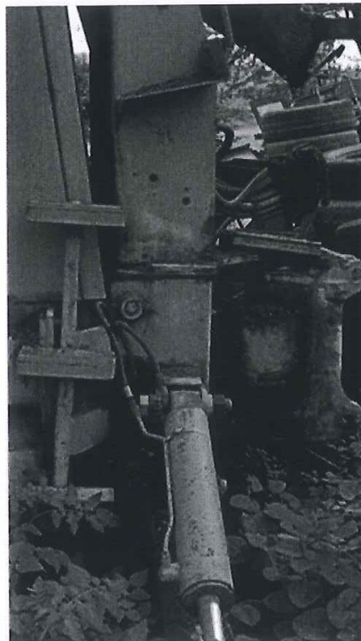
IMAGEN 05: Sistema hidráulico requiere reparación general
