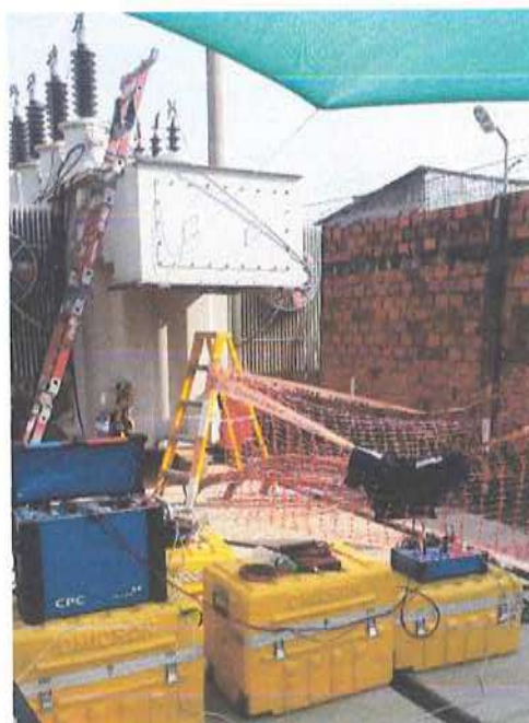
Ilustración 11.- Prueba de relación de transformación en transformador
