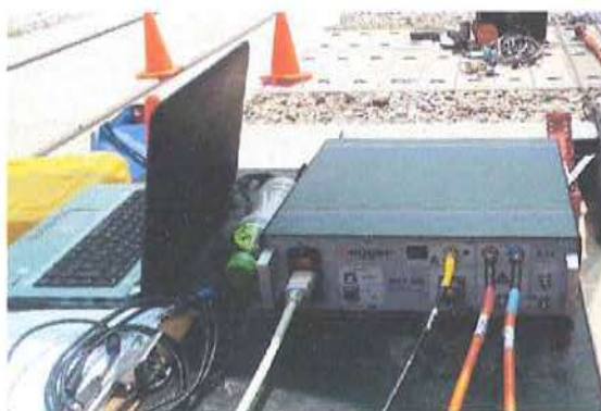
Ilustración 10.- Ejecución de prueba de DFR en el transformador
