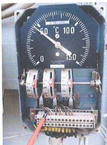
Ilustración 12.- Prueba de imagen térmica
