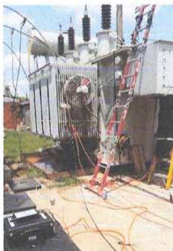
Ilustración 9.- Prueba de SFRA en el transformador
