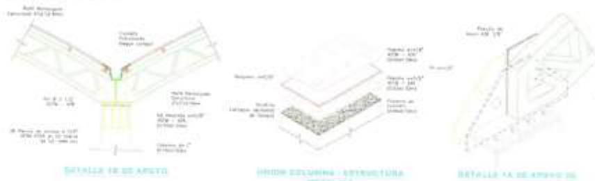
Figura: Montaje e instalación de apoyo de armaduras principales
