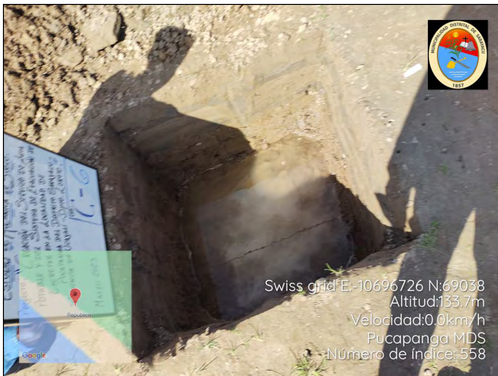
VISTA DEL PERFIL ESTRATIGRAFICO DE SUELO DE LA CALICATA N° 6
