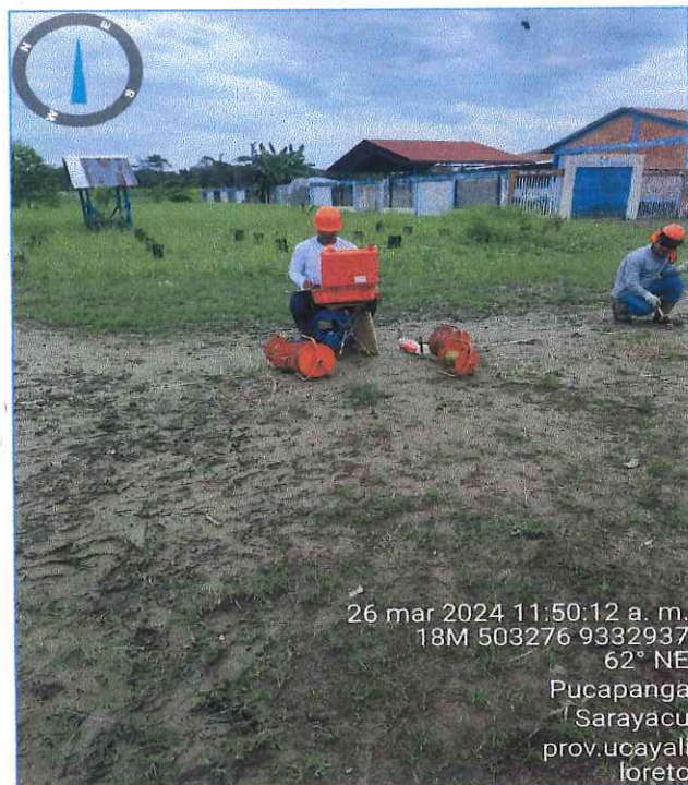
Imagen N° 7: Vista de registro de datos en la Ejecución de los SEVs- C.P. Puca panga
