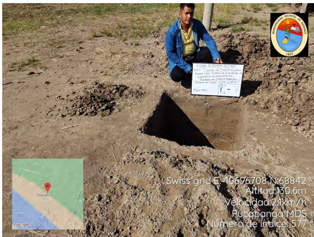
VISTA DEL PERFIL ESTRATIGRAFICO DE SUELO DE LA CALICATA N° 7
