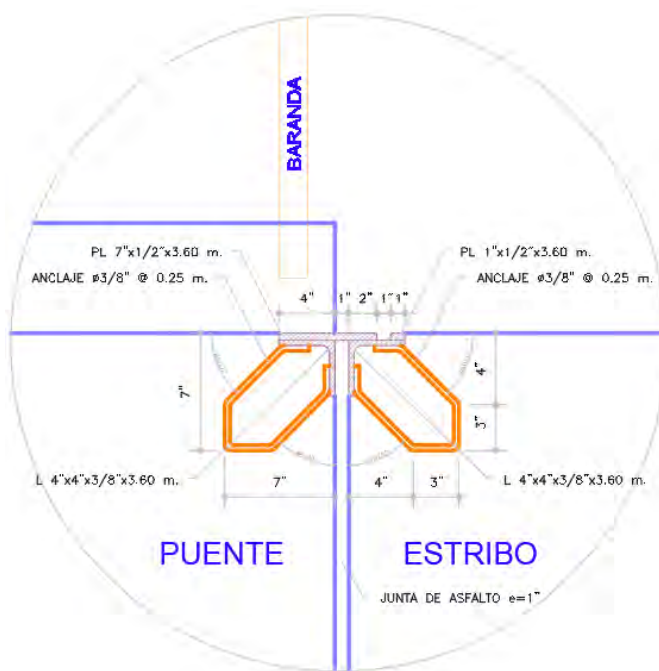
Gráfico N°38: Detalle de colocación de juntas de dilatación
