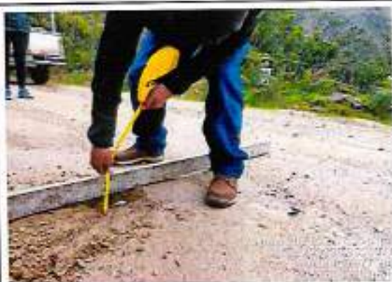
Foto 121: Espesor de afirmado - progresiva km 62+340
