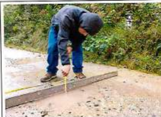
Foto 166: Espesor de afirmado + progresiva 70+740
