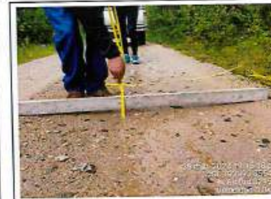
Foto 102: Ahuellamiento, Erosión y Baches - Progresiva km 58+610
