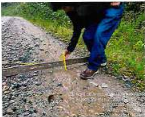
Foto 203: Espesor de afirmado - progresiva km 79+000
