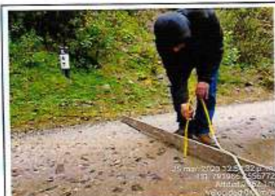
Foto 139: Ahuellamiento Erosion y baches - progresiva 66+130
