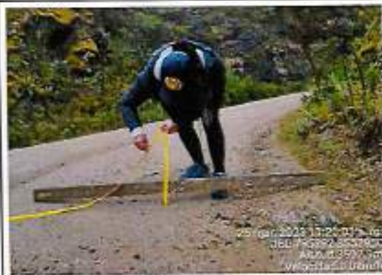
Foto 76: Espesor de afirmado - Progresiva km 54+500
