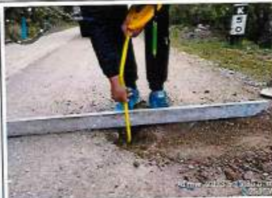
Foto 38: Espesor de afirmado - Progresiva 49+430
