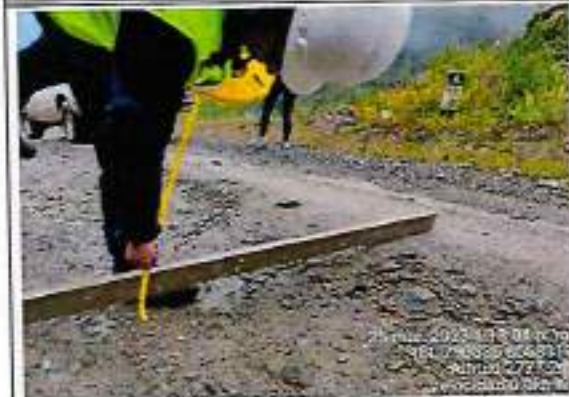
Foto 150: Ahuellamiento erosión y baches - progresiva km 67+500
