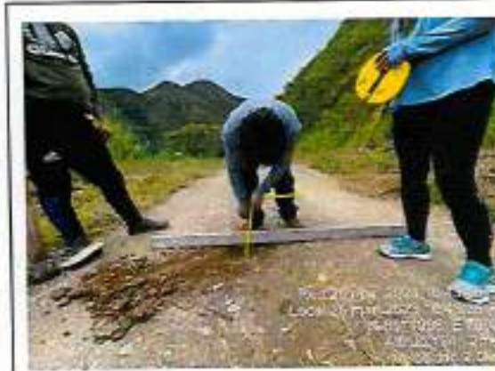
Foto 274: espesor de afirmado - progresiva km 95+000
