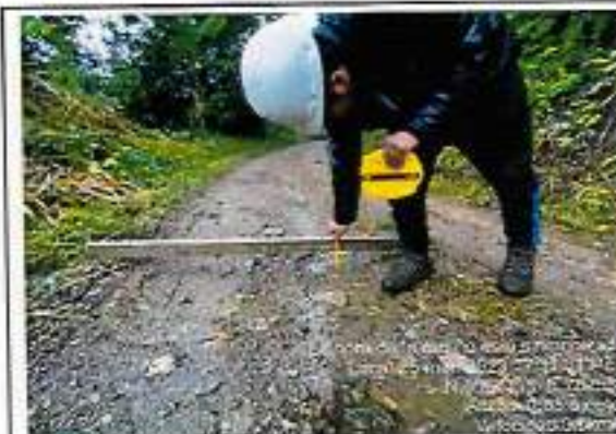
Foto 248: Espesor de afirmado - progresiva km 90+000
