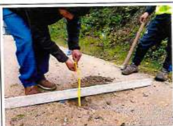
Foto 103: Espesor de afirmado - Progresiva km 58+610
