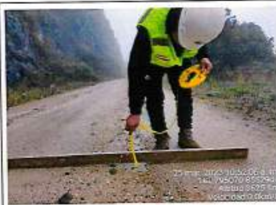
Foto 62: Ahuellamiento, Erosion, Baches - Progresiva km 52+700
