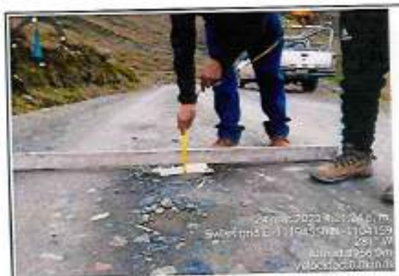
Foto 03: Espesor del afirmado - progresiva 45+000
