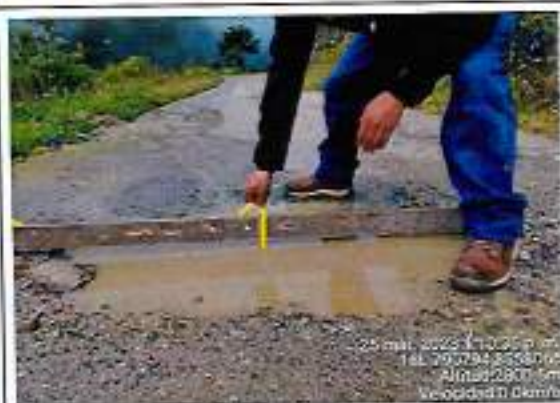
Foto 149: Espesor de afirmado - progresiva km 67+500
