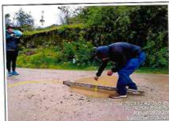
Foto 127: ahuellamiento erosion y baches - progresiva km 63+270
